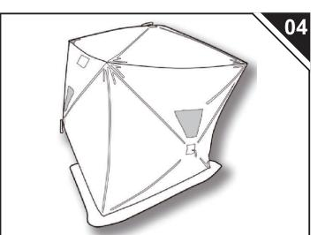
Soulevez le toit de l'abri vers le haut, tirez vers l'extérieur sur le centre de l'un des murs. Continuez autour de l'abri entier, tirez chaque moyeu de mur jusqu'à ce que tous les murs soient mis en place.
