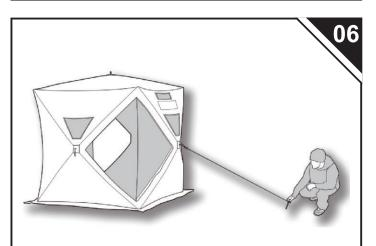
Trouvez le côté de la tente de pêche qui fait face au vent, et attachez l'une des sangles fournies aux moyeux centrals de ce mur. Étirez la sangle dans le vent et avec le reste de la pointe de glace, fixez la sangle à la glace
