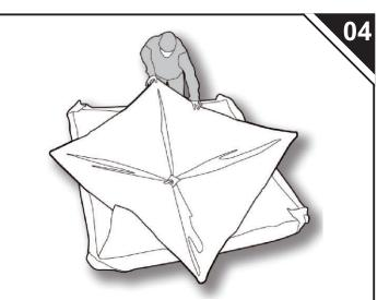
Une fois que l'appareil est posé à plat, soulevez chacun des coins ensemble et tenez l'appareil plié avec tous les moyeux orientés vers le bas.
