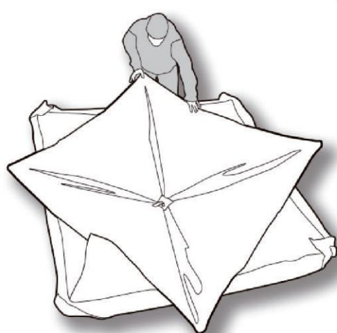
Une fois que l'appareil est posé à plat, soulevez chacun des coins ensemble et tenez l'appareil plié avec tous les moyeux orientés vers le bas.
