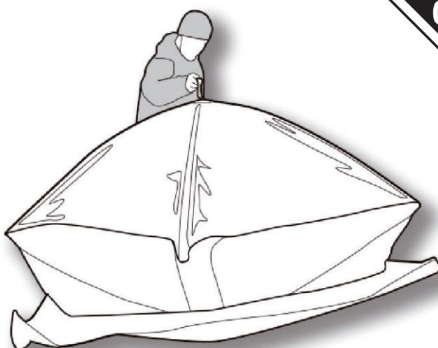
Poussez fermement vers le bas sur le moyeu central (s) du toit avec la paume de votre main jusqu'à ce que le toit s'aplatisse sur les côtés.
