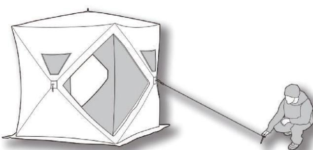
Trouvez le côté de la tente de pêche qui fait face au vent, et attachez l'une des sangles fournies aux moyeux centraux de ce mur. Étirez la sangle dans le vent et avec le reste de la pointe de glace, fixez la sangle à la glace
