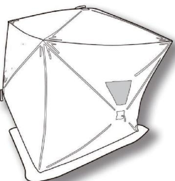
Soulevez le toit de l'abri vers le haut, tirez vers l'extérieur sur le centre de l'un des murs. Continuez autour de l'abri entier, tirez chaque moyeu de mur jusqu'à ce que tous les murs soient mis en place.
