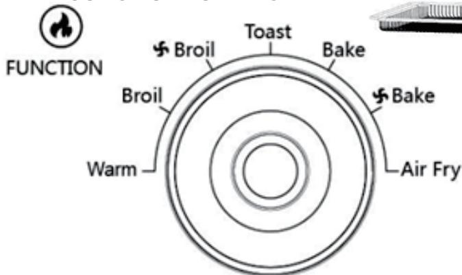
**Warm:** Drehen Sie den Bedienknopf und den Temperaturregler auf warm. Drehen Sie dann den Timer-Bedienknopf auf die gewünschte Zeit, um den Ofen zu starten und mit dem Aufwärmen zu beginnen.
