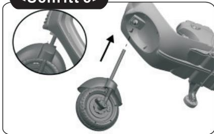
5. Stecken Sie die Vorderradstange in das Loch der Karosserie, stellen Sie sicher, dass sie richtig sitzt.
