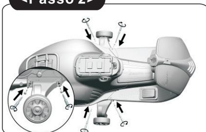
2. Fissare la ruota laterale con quattro viti M4×14 con un cacciavite (non in dotazione).
