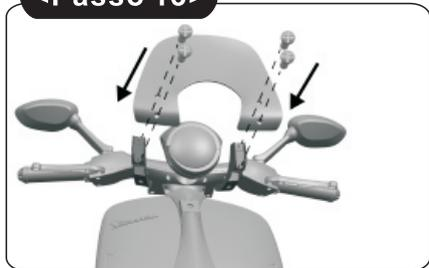
13. Colocar o pára-brisas na posição correta do guidador, depois apertar com quatro parafusos M3x10.
