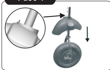
4. Inserte la palanca de la rueda delantera a través del guardabarros delantero.
