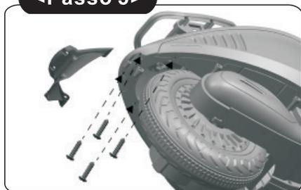
3. Posizionare il parafango posteriore sulla posizione nella parte posteriore del corpo, fissare con quattro viti M4X14 con un cacciavite (non in dotazione).
