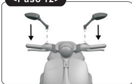
12. Inserte el espejo retrovisor en el orificio del manillar, asegúrese de que los espejos retrovisores estén completamente fijados.
