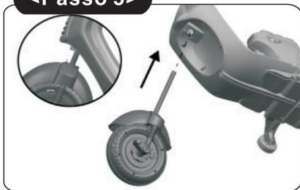
5. Inserir o eixo da roda dianteira no orifício da estrutura, certificar-se da posição correta.
