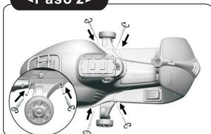
2. Apriete las ruedas con cuatro tornillos M4x14 con un destornillador (no incluido).
