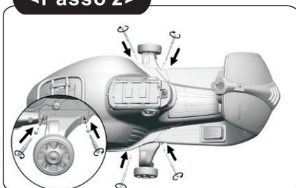
2. Apertar a roda por quatro parafusos M4x14 com uma chave de fendas (não incluída).
