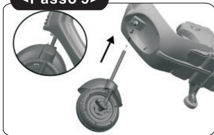
5. Inserire l'asta della ruota anteriore nel foro del corpo, assicurandosi della giusta posizione.
