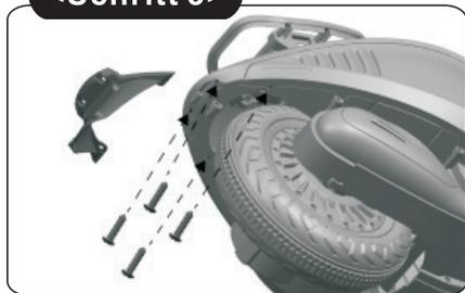
3. Stecken Sie das hintere Schutzblech in die Stelle hinten in der Karosserie und ziehen Sie es mit vier M4 × 14 Schrauben mit einem Schraubendreher fest. (nicht mitgeliefert)
