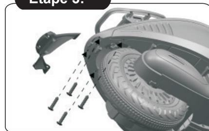
3. Placez le garde-boue arrière sur l'emplacement à l'arrière du corps, serrez avec quatre vis M4×14 à l'aide d'un tournevis (non inclus).
