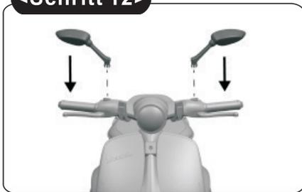
12. Stecken Sie den Rückspiegel in das Loch des Lenkers ein. Achten Sie darauf, dass die Rückspiegel vollständig fixiert sind.
