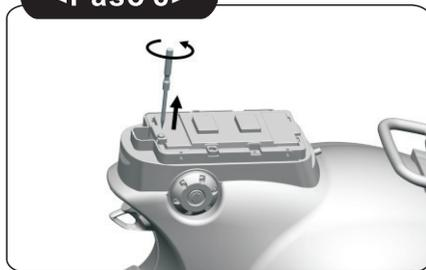
8. Afloje el tornillo con un destornillador (no incluido).
