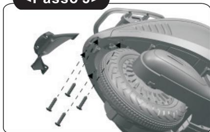
3. Colocar o pára-lamas traseiro sobre o local na parte traseira da estrutura, apertar os quatro parafusos M4x14 com uma chave de fendas (não incluída).
