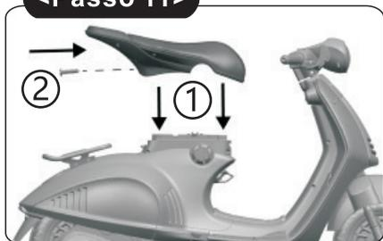
11. Colocar o assento no local da estrutura, depois apertar com um parafuso M4x14.
