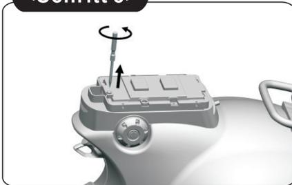
8. Lösen Sie die Schraube mit einem Schraubendreher (nicht mitgeliefert).
