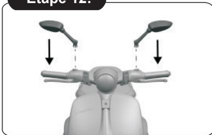
12. Insérez le rétroviseur dans le trou du guidon, assurez-vous que les rétroviseurs sont complètement fixés.
