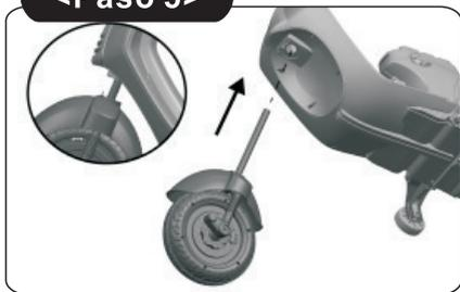
5. Inserte el tubo de la rueda delantera en el orificio del cuerpo, asegúrese de que esté en la posición correcta.
