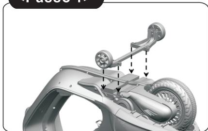
1. Posizionare la ruota laterale sulla posizione nella parte inferiore della moto.
