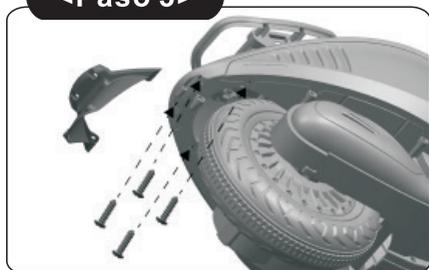
3. Coloque el guardabarros trasero sobre la ubicación en la parte trasera del cuerpo, apretar con cuatro tornillos M4x14 con un destornillador (no incluido).
