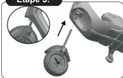
5. Insérez le bâton de la roue avant dans le trou du corps, assurez-vous de la bonne position.
