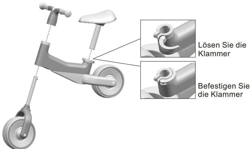
1. Setzen Sie den Vorderradsatz wie in der Abbildung gezeigt in das untere Loch des Gehäuses ein, und fixieren Sie dann den Lenker mit dem Vorderrad.
