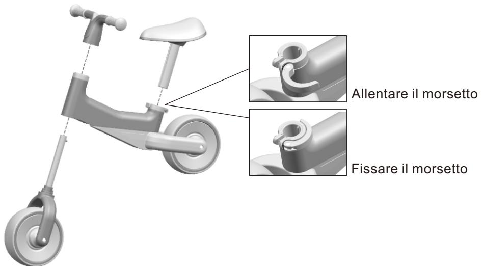
1. Inserire la ruota anteriore dal foro inferiore del corpo come mostrato in figura, e poi fissare il manubrio con la ruota anteriore.
