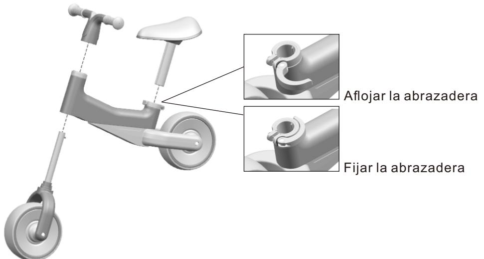
1. Inserte el juego de ruedas delanteras desde el orificio inferior del cuerpo como se muestra en la figura, y luego fije el manillar con la rueda delantera.
