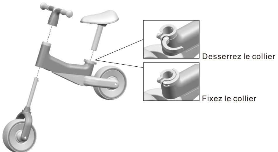
1. Insérez le jeu de roues avant depuis le trou inférieur du corps comme indiqué dans la Figure, puis fixez le guidon avec la roue avant.
