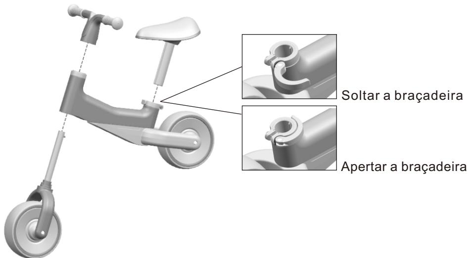
1. Inserir o conjunto da roda dianteira a partir do orifício inferior da estrutura, como mostrado no figure, depois fixar a barra do guiador com roda dianteira.
