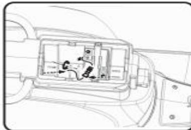
7. Wenn die Batterie installiert ist, stecken Sie die rote Kabelklemme in den positiven Pol der Batterie.
