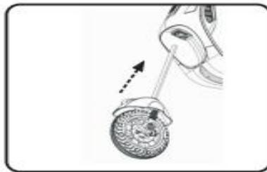
4. Setzen Sie den Vorderradknüppel in das Loch des Rollerkörpers ein.
