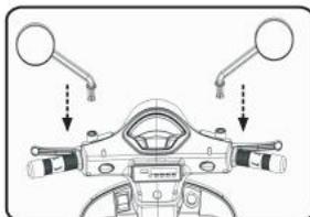
9. Setzen Sie den Rückspiegel in das Loch der Lenkerstange ein, achten Sie darauf, dass die Rückspiegel vollständig befestigt sind.
