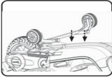
1. Legen Sie das Seitenrad über die Stelle an der Unterseite des Rollerkörpers und ziehen Sie es mit sechs Schrauben mit einem Schraubenzieher fest (nicht im Lieferumfang enthalten)
