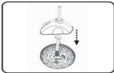
3. Stecken Sie den Vorderradstiel durch den vorderen Kotflügel.
