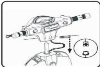
6. Legen Sie die Lenkerstange über den Vorderradstock, führen Sie den Bolzen in das Loch ein und ziehen Sie ihn mit einem Schraubenzieher
