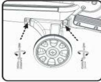
2. Setzen Sie den hinteren Kotflügel über den hinteren Teil des Rollerkörpers und ziehen Sie ihn mit einer  $\phi 4 \times 4$  Schraube mit einem Schraubenzieher fest
