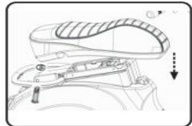
8. Setzen Sie den Sitz an die Stelle im Rollerkörper, führen Sie den Bolzen in das Loch ein und ziehen Sie die Mutter fest
