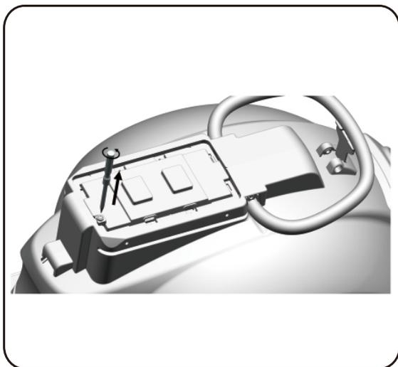
9. Desserrer la vis à l'aide d'un tournevis (non fourni).
