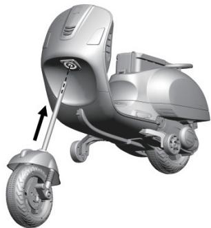
5.Inserte la varilla de la rueda frontal en el orificio de la carrocería de la motocicleta.
