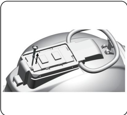
9.Utilice un destornillador (no incluido) para aflojar el tornillo.
