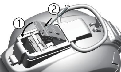
11.Fermer le couvercle de la batterie et serrez la vis à l'aide d'un tournevis (non fourni).
