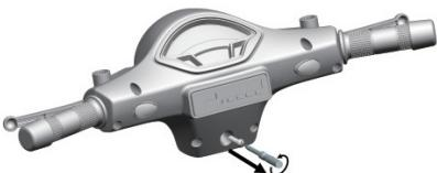
6.Desserrer le boulon à l'aide d'un tournevis (non fourni) et retirer le boulon.
