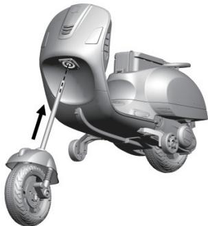
5. Inserire l'asta dello sterzo della ruota anteriore nel foro del corpo della motocicletta.
