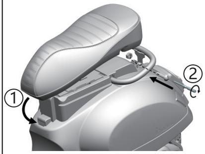
12.Enfoncer la selle dans l'emplacement prévu dans la carrosserie de la moto, puis visser le boulon dans le trou et serrer l'écrou.
