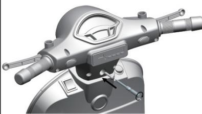
8. Posizionare il manubrio sopra l'asta dello sterzo della ruota anteriore, inserire il bullone nel foro e fissare con un cacciavite (non incluso).
