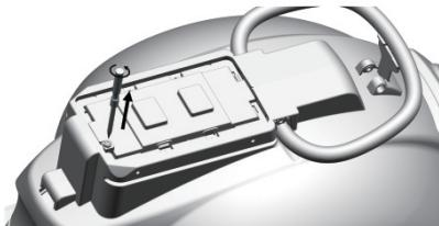
9. Desserrer la vis à l'aide d'un tournevis (non fourni).
