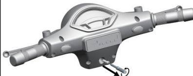
6.Utilice un destornillador (no incluido) para aflojar el perno y retire el perno.
