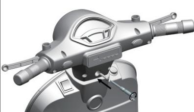
8.Coloque el manillar en la varilla de la rueda frontal, inserte el perno en el orificio y utilice un destornillador (no incluido) para apretarlo.
