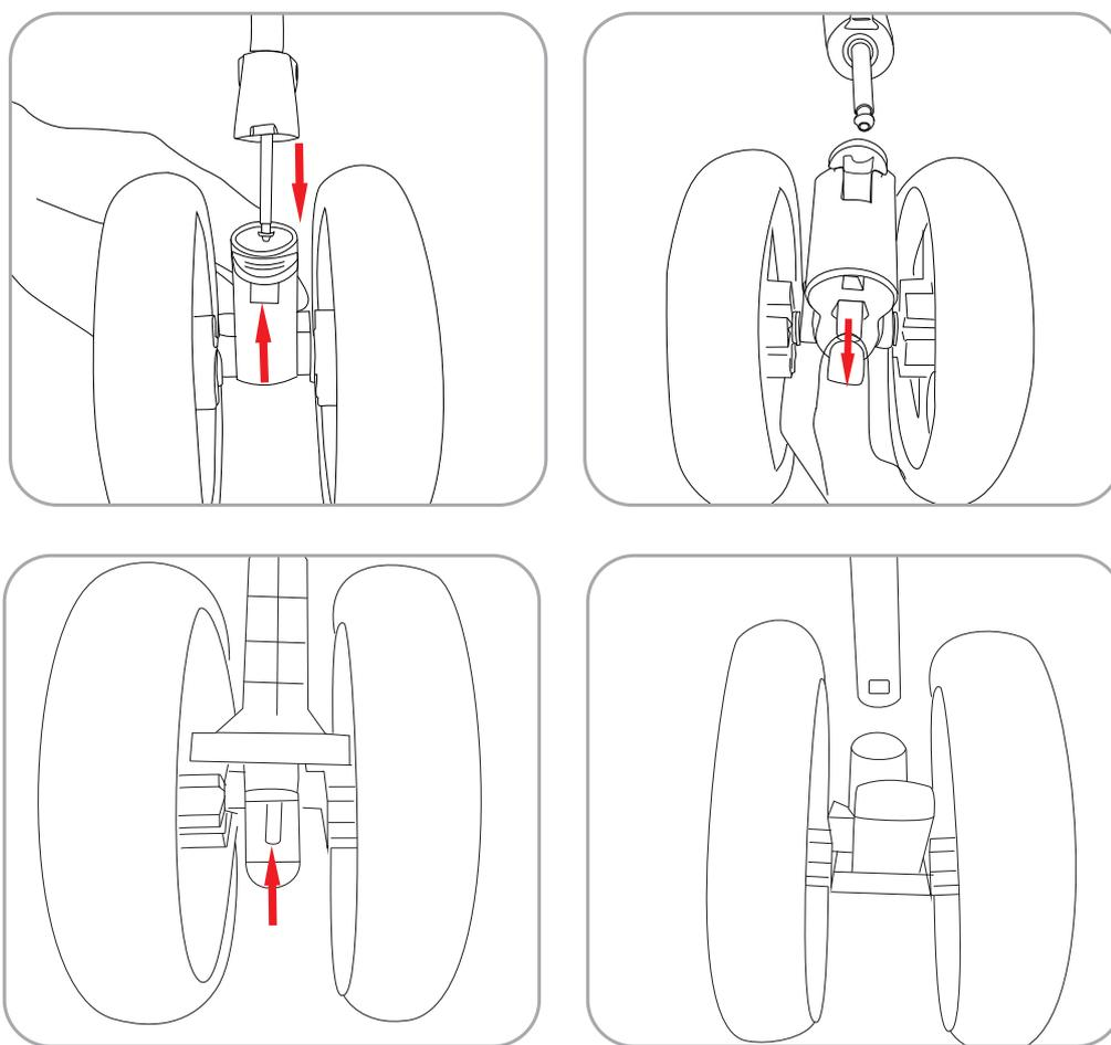
**1. Instalar y desmontar las ruedas delanteras:**
