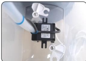
2. Befestigen Sie die Pumpe am Boden des Tanks
