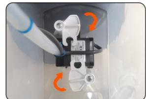
3. Drehen Sie die Tablette auf die Wasserpumpe, um sie zu sichern
