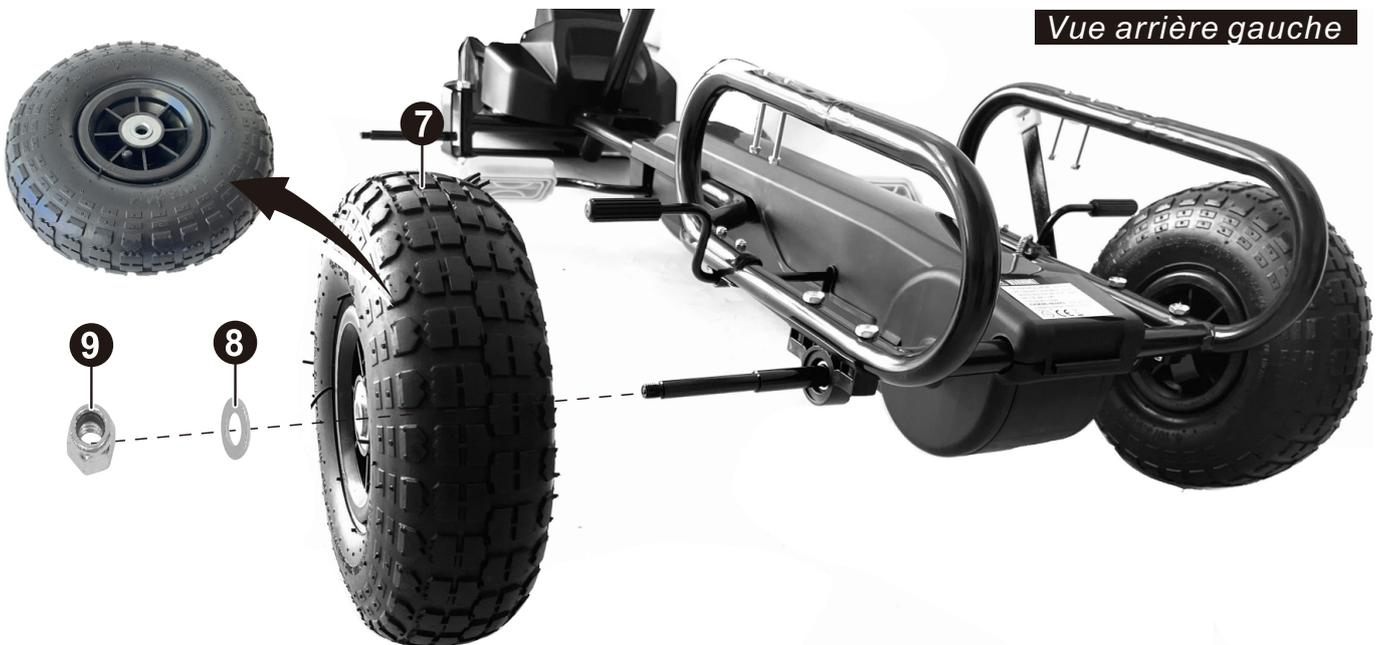
7. Faites glisser la roue arrière dans l'essieu arrière.
