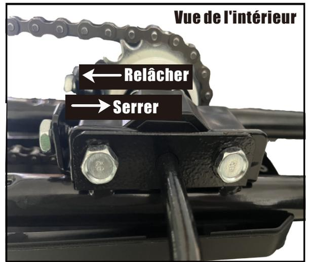
La chaîne doit être à la bonne étanchéité. Si elle est trop serrée, il sera difficile de pédaler. Si elle est trop desserrée, la chaîne peut se détacher des pignons.
