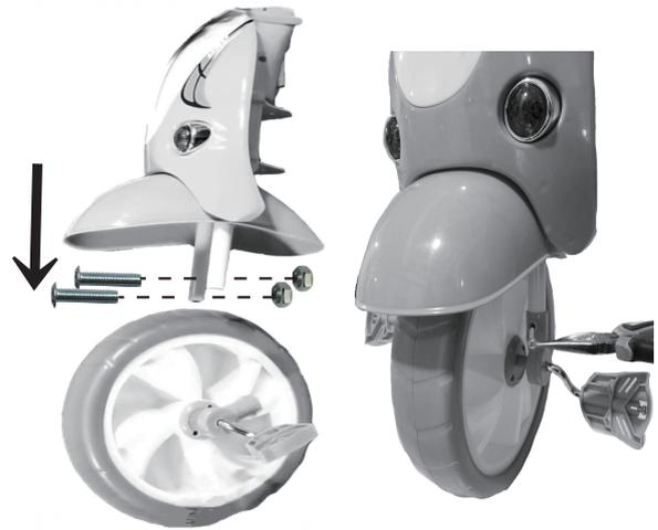
2. Ensamble la rueda delantera y fijela con 2 tuercas y tornillos (5\*28)
