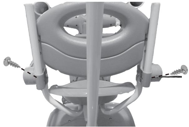
14. Inserte el soporte de acero del dosel en el respaldo, fíjelo con 2 tornillos autorroscantes (3,5 \* 10).
