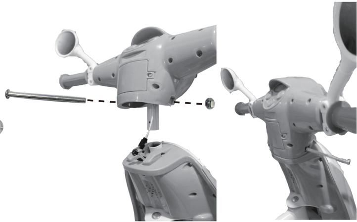
12. Conecte el cable de alimentación (cabezal y carrocería ), fije el cabezal con música en la carrocería del automóvil y fíjelo con los tornillos y tuercas(5\*90).
