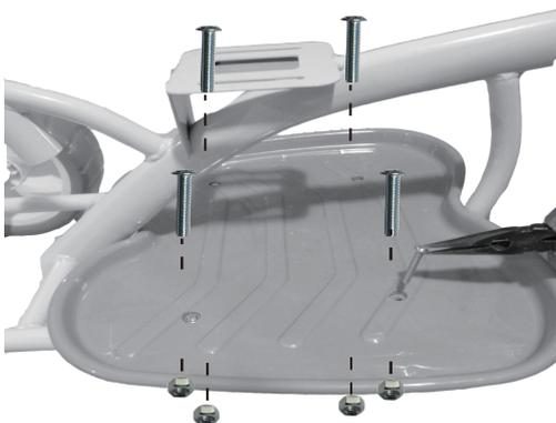
5. Ensamble el pedal grande y fijelo con 4 tuercas y tornillos (5\*28)
