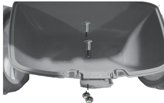
9. Ensamble la caja de herramientas y fíjela con 2 tuercas y tornillos(5\*10)
