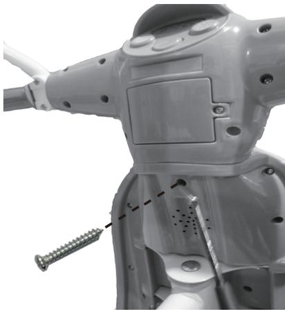
13. Use un tornillo (4\*25) para fortalecer la conexión entre el cabezal con música y la carrocería del automóvil.
