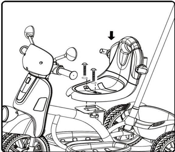
6. Fissare prima il sedile e lo schienale insieme sul telaio, usando la guarnizione e la vite (6 \* 30 X2) per fissarli in posizione.
