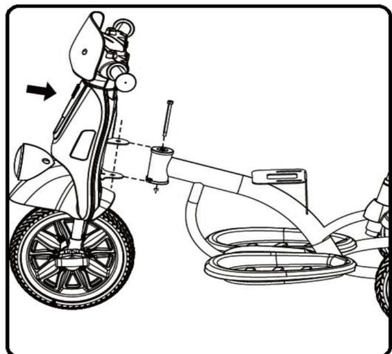
5. Assemblare la carrozzeria al telaio utilizzare una vite (7,8 \* 90).
