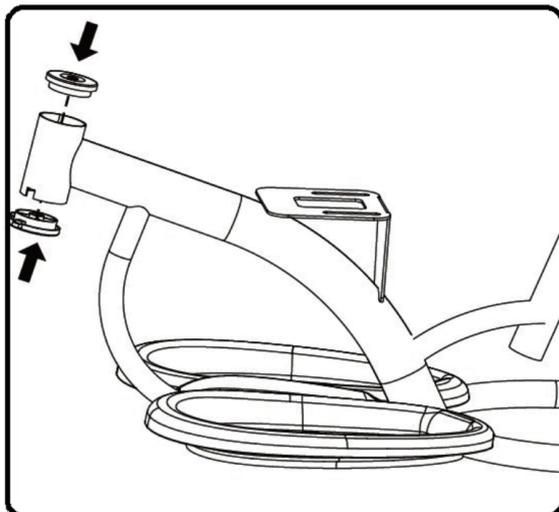
4. Fissare la parte in plastica del telaio anteriore.
