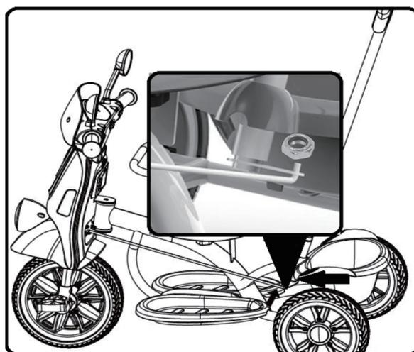
11. Assemblare il controllo direzionale e fissarlo in posizione con un controdado.
