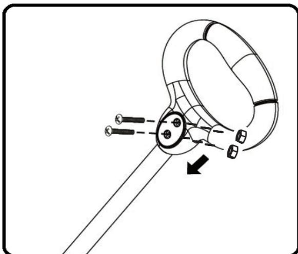
10. Fissare la maniglia di spinta sulla barra di spinta, con due (5 \* 28) dadi e viti.
