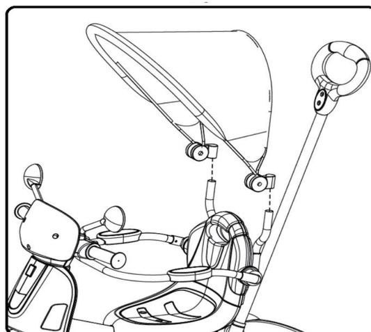
15. Inserire il tettuccio alla carrozzeria e spingere il soffitto per aprirlo.
