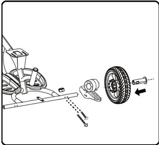
3. Come mostrato dalla freccia, inserire il disco del freno, la ruota e il manicotto nell'asse posteriore, Fissando il freno con viti e dadi (4 \* 40 x2) e fissando la ruota con viti autofilettanti (4 \* 16 x2 ).
