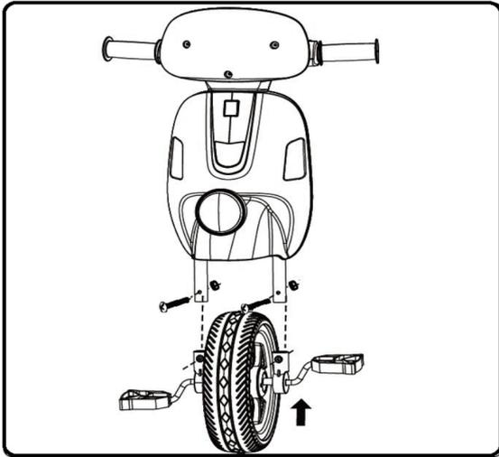
1. assemblare la ruota frontale e fissare con due viti e dadi (5\*28)
