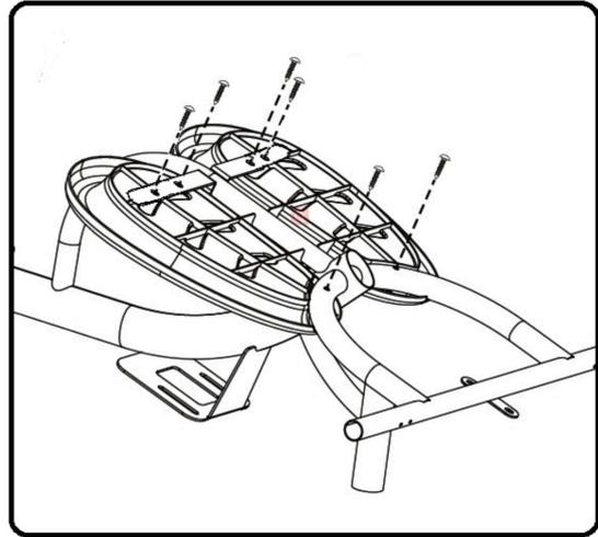
2. Assemblare il pedale grande fissandolo con sei (4 × 8) viti autofilettanti.
