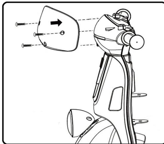
13. Assemblare il parabrezza e fissarlo con tre (4 \* 10) viti autofilettanti.
