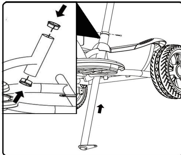
9. Fissare la parte in plastica del telaio posteriore inserendo la barra di spinta nel foro e inserendo la parte fissa in plastica della barra di spinta con una vite (3,5 \* 10).
