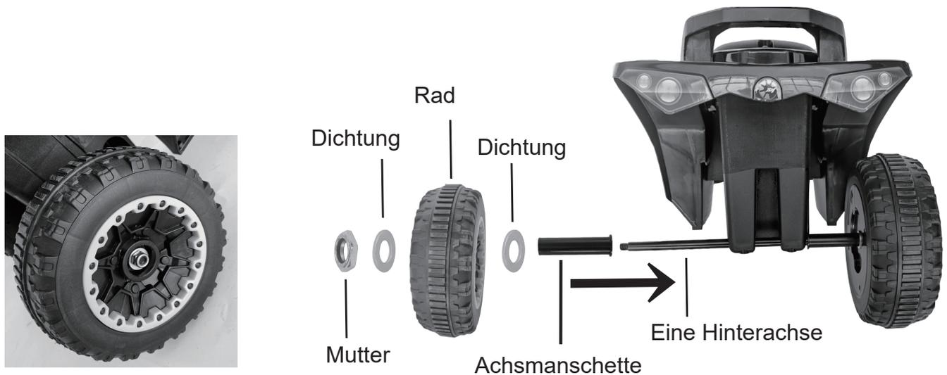
Der Einbau des anderen Seitenrades erfolgt gemäß Schritt 1.
