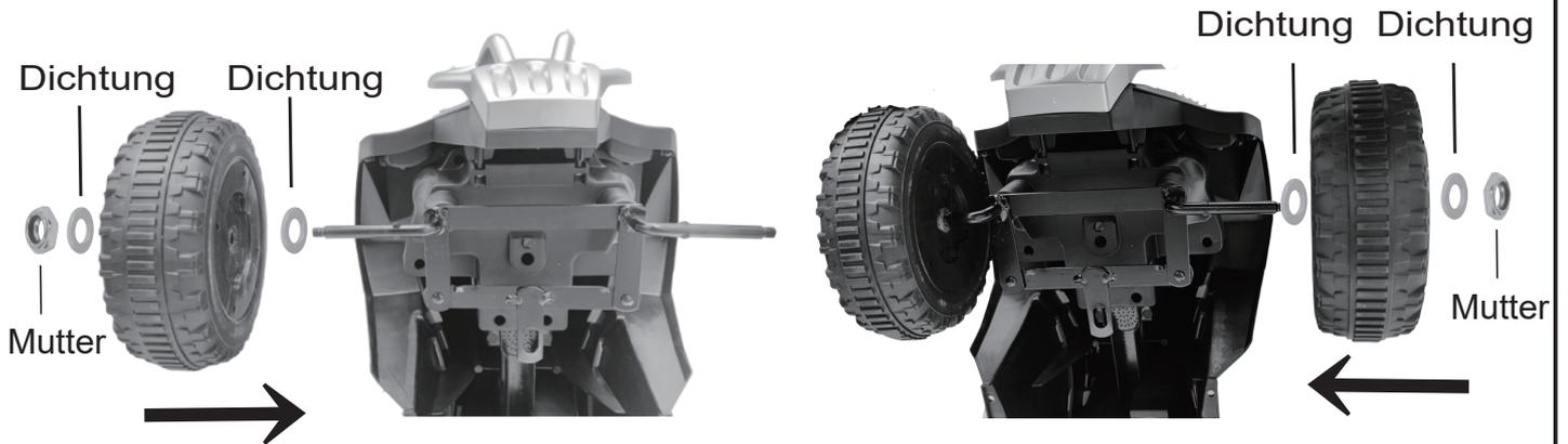
Wie anhand des Pfeils angezeigt, führen Sie die Dichtung, das Rad, die Dichtung und die Mutter durch die Vorderachse und ziehen Sie die Mutter im Uhrzeigersinn an
