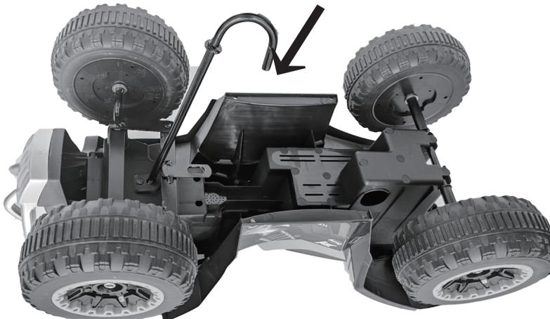
Stellen Sie das Fahrzeug auf den Kopf und setzen Sie die Lenkwelle ein
