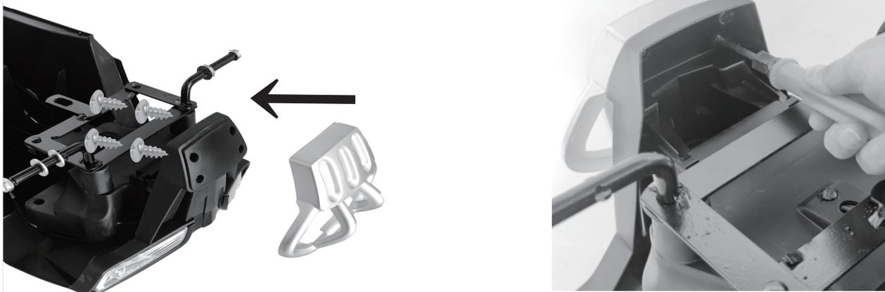
Montieren Sie die Stoßstange an der Vorderseite des Fahrzeugs, wie durch den Pfeil gezeigt, und schrauben Sie sie fest (4x(4x10) SCHRAUBE)
