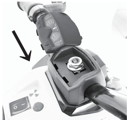
Stecken Sie den Griffstange in die Lenkwelle, setzen Sie die Dichtung ein und sichern Sie sie mit einer Mutter(M10\*1)
