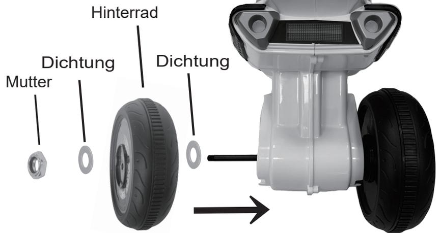
Der Einbau des anderen Seitenrades erfolgt gemäß Schritt 1.
