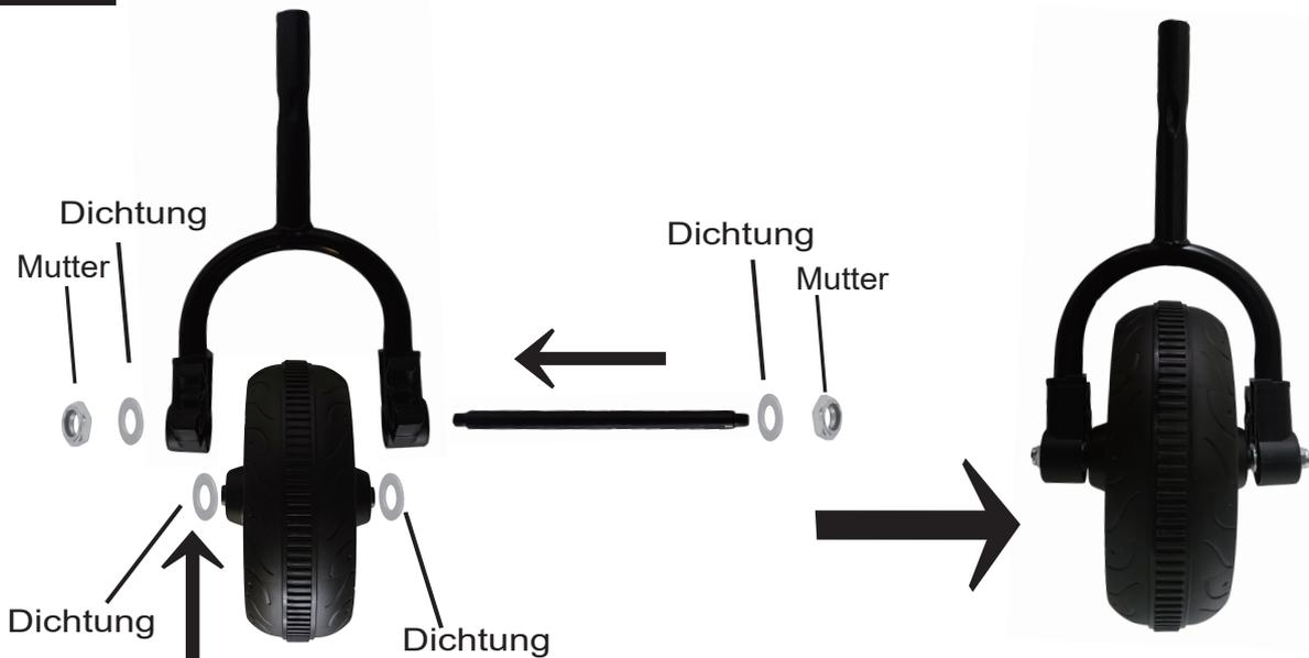
Führen Sie die Welle, wie im Pfeil dargestellt, in die Vordergabel ein, führen Sie sie durch die Dichtung X2, das Vorderrad, die Dichtung X2 und die Mutter (wie in der Abbildung dargestellt) und ziehen Sie die Mutter im Uhrzeigersinn an
