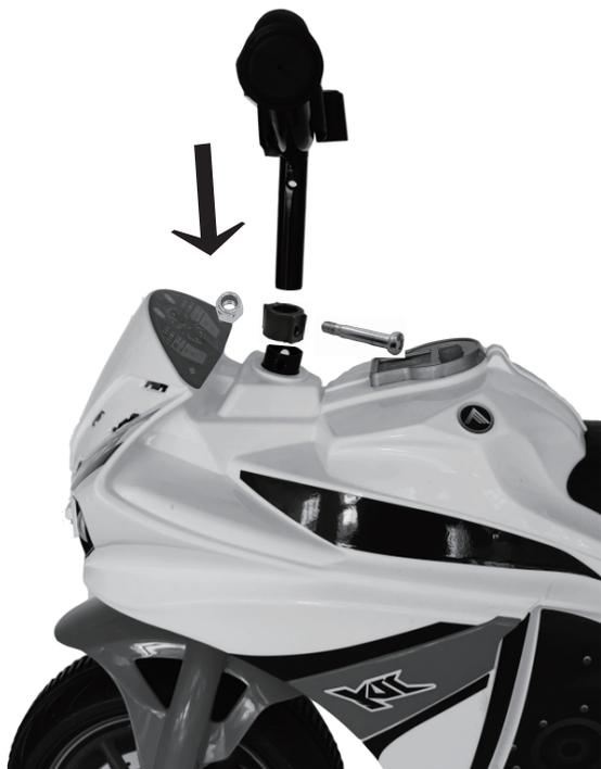
Befestigen Sie die Griffstange & die Gewindehülse
