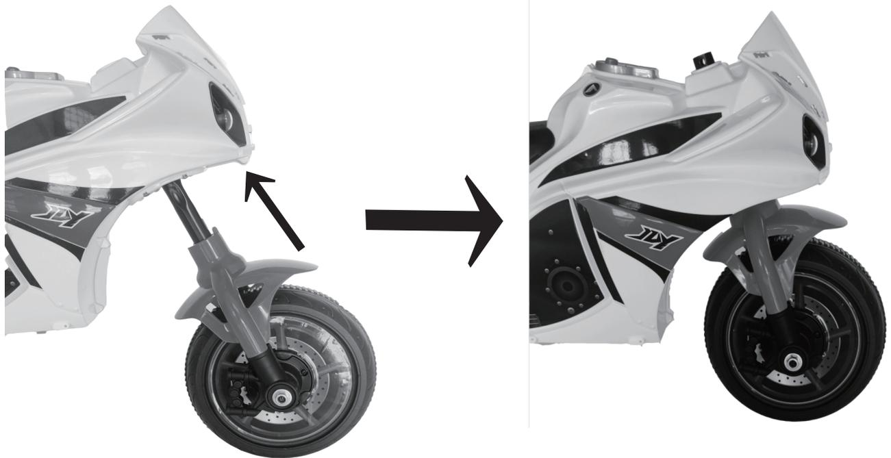
Setzen Sie die Vorderradgabel in das Chassis ein und drücken Sie sie fest
