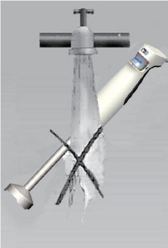
Nettoyez le bloc moteur et le couvercle du bol à découper uniquement avec un chiffon humide. **Ne pas plonger le moteur dans l'eau !**
