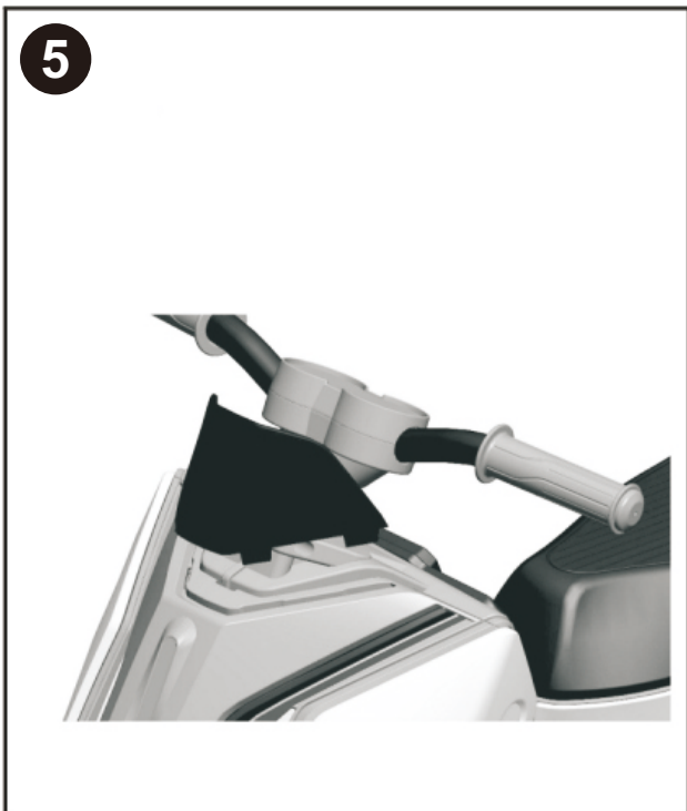
5 Assemblaggio paravento Inserire il parabrezza nelle apposite fessure sulla carrozzeria.
