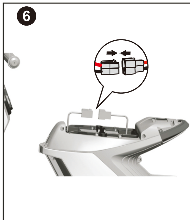
6 Montaje de la batería Enchufe el conector como lo que se muestra en la imagen.
