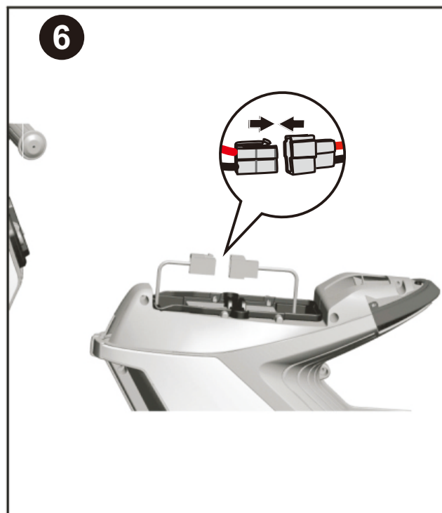
6 Assemblaggio batteria Collegare la spina come mostrato in figura.
