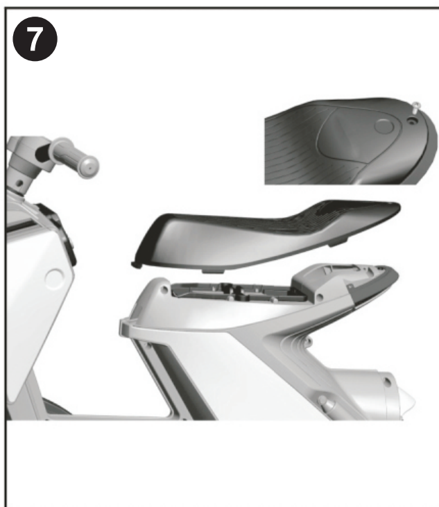
7 Assemblage du siège Insérer le siège dans les fentes du corps principal, le fixer à l'aide d'une vis.
