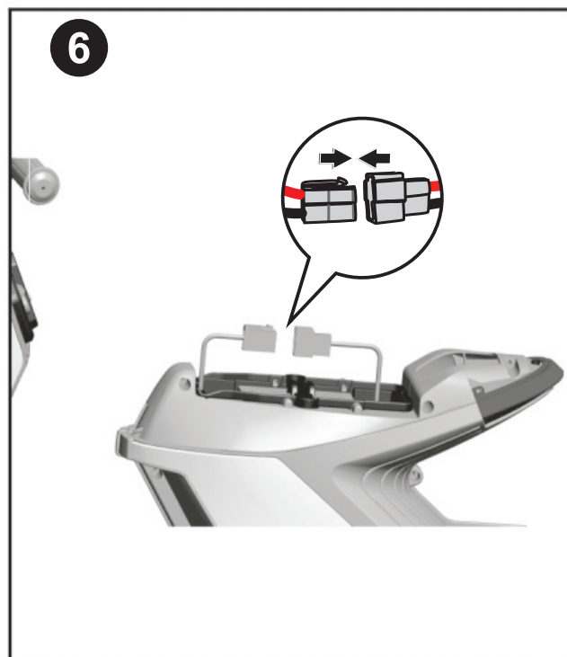
6 Assemblage de la batterie Branchez la fiche comme indiqué sur l'image.
