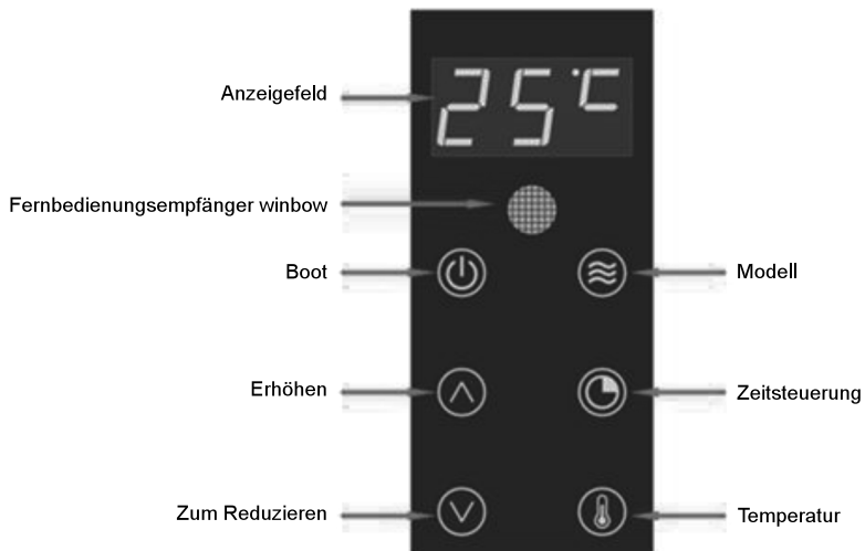
Abbildung 3 ist eine schematische Ansicht des Bedienfeldes
