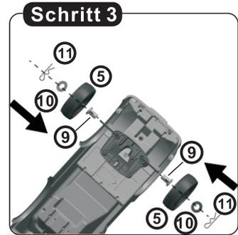
3. Montieren Sie die beiden Vorderräder, setzen Sie den Kunststoffring, das Rad und die Unterlegscheibe ein und ziehen Sie sie mit einem Splint fest.
