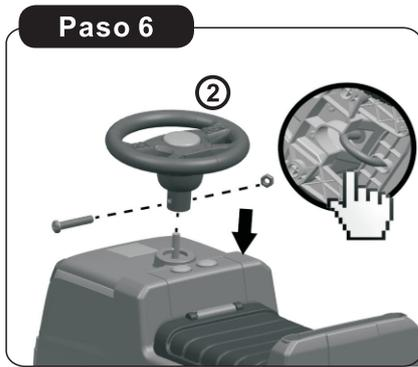
6. En primer lugar, afloje el perno y la tuerca en el volante, entonces coloque el volante sobre el palo en forma de J, inserte el perno y apriételo con la tuerca utilizando un destornillador.
