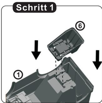
1. Setzen Sie den Kippsicherungsboden in die Rückseite der Karosserie ein.
