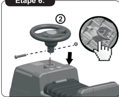
6. Desserrer le boulon et l'écrou dans le volant d'abord, puis placer le volant sur le bâton en forme de J, insérer le boulon et serrer l'écrou avec un tournevis.
