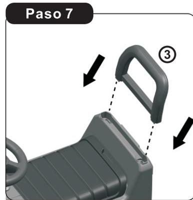
7. Inserte el respaldo sobre el orificio en la parte trasera de la carrocería, asegúrese de que el respaldo esté fijado en su lugar completamente.
