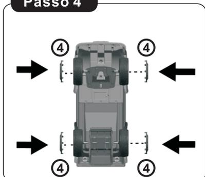
4. Posizionare i quattro cerchioni delle ruote nelle quattro ruote.
