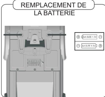
Retourner la carrosserie de la voiture, et trouver le logement de la batterie. Desserrer les vis avec un tournevis.
