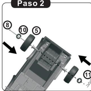
2. Inserte el eje de la rueda trasera a través de la arandela, la rueda y el anillo de plástico en la carrocería, luego apriételos firmemente utilizando el pasador de chaveta.
