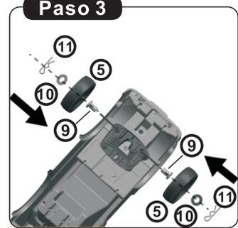
3. Monte las 2 ruedas frontales, inserte el anillo de plástico, la rueda y la arandela, apriételos firmemente utilizando un pasador de chaveta.
