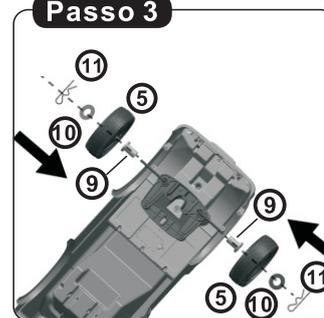
3. Assemblare le due ruote anteriori, inserire l'anello di plastica, la ruota e la rondella, fissare con una coppia.
