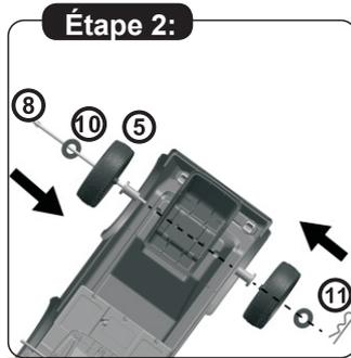
2. Insérer l'essieu arrière à travers la rondelle, la roue, l'anneau en plastique dans la carrosserie, serrer à l'aide d'une goupille fendue.
