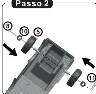
2. Inserire l'asse della ruota posteriore attraverso la rondella, la ruota e l'anello di plastica nel veicolo, fissare con una coppia.
