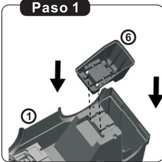
1. Coloque el estante anti-caída en la parte trasera de la carrocería.
