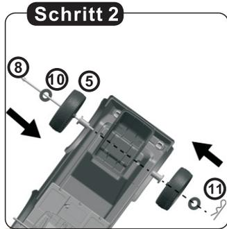
2. Führen Sie die Hinterradachse durch die Unterlegscheibe, das Rad, den Kunststoffring in die Karosserie ein, mit Splint festziehen.
