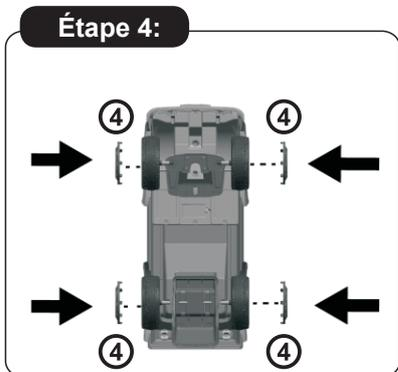
4. Placer les quatre capuchons de roue sur les quatre roues.
