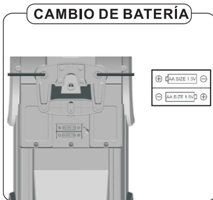
Dale la vuelta a la carrocería y encuentra el compartimento de baterías. Afloje los tornillos utilizando un destornillador. Coloque 2 baterías AA en el compartimento, entonces apriete el tornillo firmemente utilizando un destornillador.
