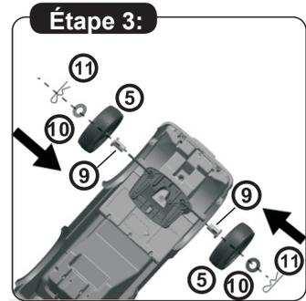
3. Assembler les deux roues avant, insérer l'anneau en plastique, la roue et la rondelle, serrer à l'aide d'une goupille fendue.
