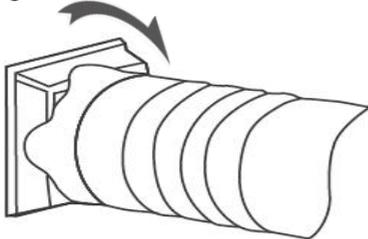
**Schritt 2:** Schließen Sie den Fensteradapter an das andere Ende des Abgasschlauchs an.
