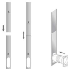
**Schritt 4:** Schließen Sie das Fenster, um den Adapter zu sichern. Der Fensteradapter muss fest an seinem Platz gehalten werden, und der Fensteradapter muss bei Bedarf mit Klebeband gesichert werden. Es wird empfohlen, den Spalt zwischen dem Adapter und den Seiten des Fensters für maximale Effizienz abzudichten.
