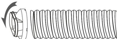
**Schritt 3:** Erweitern Sie den einstellbaren Fensteradapter um die Länge Ihres Fensters. Den Abluftschlauch an den Fensteradapter anschließen.
