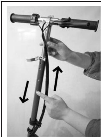
2. Presione el pasador de seguridad y levante o baje la barra en T para ajustar la altura.
