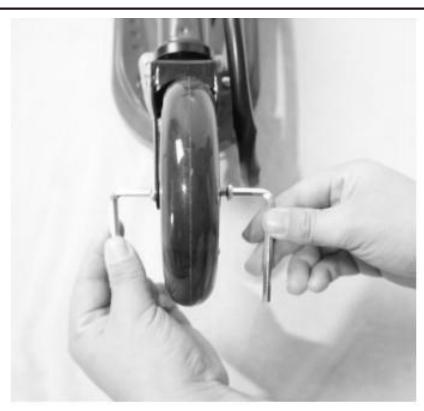
4. Utilizzare la chiave esagonale da 1\*5 mm per caricare e inserire l'asse nel foro della forcella anteriore.
