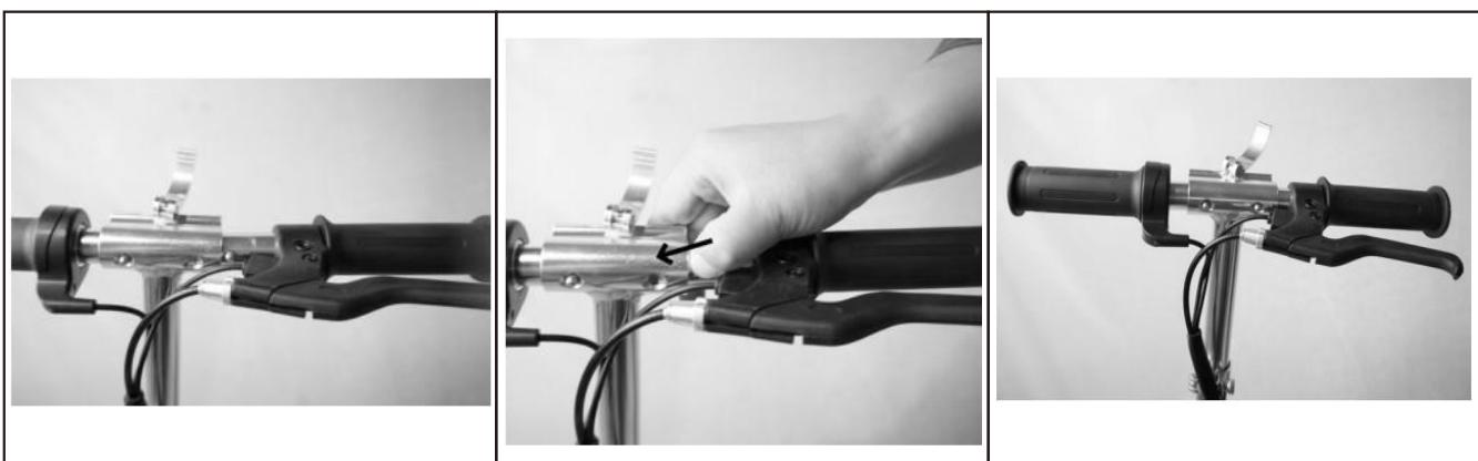
3. Inserir o guiador do travão de mão e usar o dedo para premir o pino de pressão para inserir e fixar com o orifício na barra em T do guiador.
