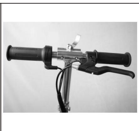
3. Inserte el manillar del freno de mano y use el dedo para presionar el pasador de presión para insertarlo y fijarlo con el orificio en la barra en T del manillar.
