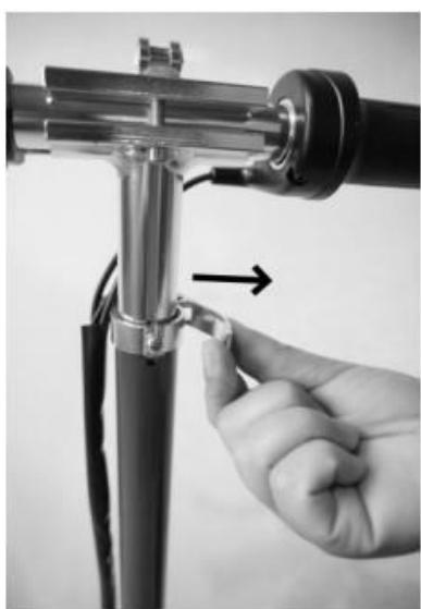
1. Abra el casillero del tubo frontal y levante la barra en T a la primera posición con el pasador de presión en el tubo frontal.
