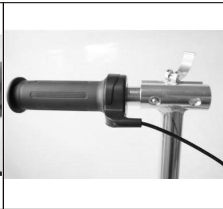
2. Inserire il manubrio destro dell'acceleratore e premere con il dito la testina di blocco per inserirla e fissarla nel foro della barra a T del manubrio.
