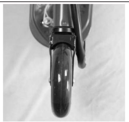
7. Gire la otra llave hexagonal para apretar el tornillo con el eje y la horquilla delantera.
