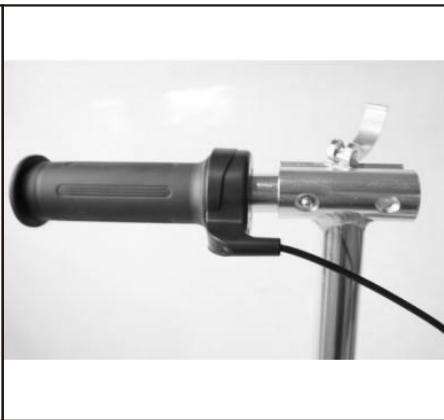
2. Inserte el manillar derecho del acelerador y use el dedo para presionar el pasador de presión para insertarlo y fijarlo con el orificio en la barra en T del manillar.
