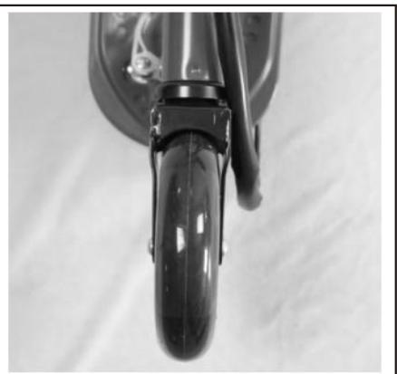
7. Rodar a chave hexagonal de ordem para apertar o parafuso com o eixo e com o garfo dianteiro.
