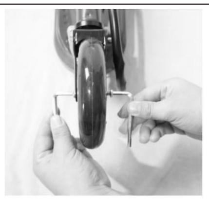
4. Usar a chave hexagonal de 1\*5mm para orientar e inserir o eixo no orifício do garfo dianteiro.
