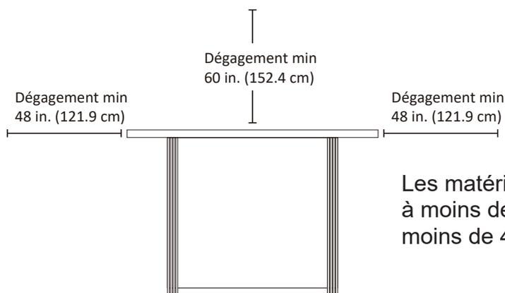
Les matériaux combustibles ne doivent pas se trouver à moins de 60 pouces du haut de l'appareil, ni à moins de 48 pouces autour de l'appareil.
