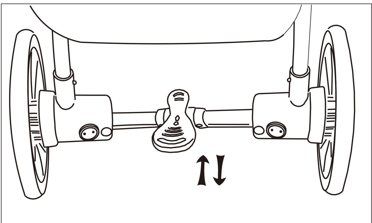
6. Per abbassare l'asta del freno per arrestare il passeggino e sollevarla per rilasciare il freno.
