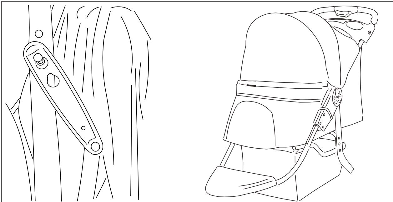
1. zum Öffnen des Kinderwagens: Lösen Sie den Klapphaken wie abgebildet, heben Sie den Lenker an, klappen Sie den Kinderwagen auf und stellen Sie sicher, dass beide Gelenke verriegelt sind.
