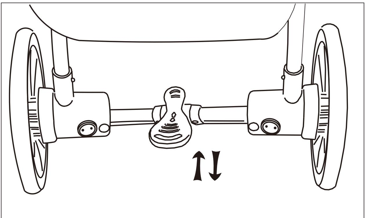
6. Para pisar el freno, baje la barra para detener el cochecito y levántela para soltar el freno.
