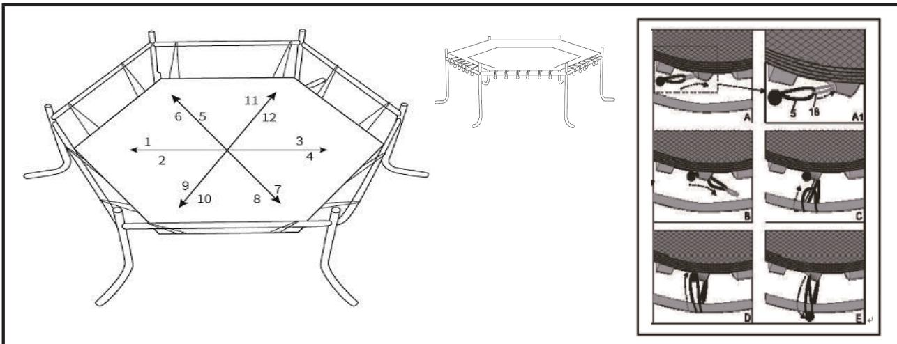
4. Inserire i pali superiore e inferiore della rete nel telaio rispettivamente come mostrato in figura.
