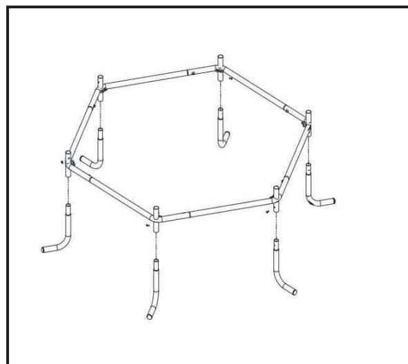
2. Instale el tubo de la pata en forma de "L" en el marco principal sucesivamente, y apriete los tornillos con la herramienta.
