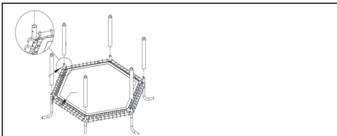
5. Bitte befestigen Sie das Netz von oben nach unten am Hauptgestell mit der Befestigungsschnalle des Netzes am Ballkopf und binden Sie das darunter liegende Gummiband an das darunter liegende Rohr.
