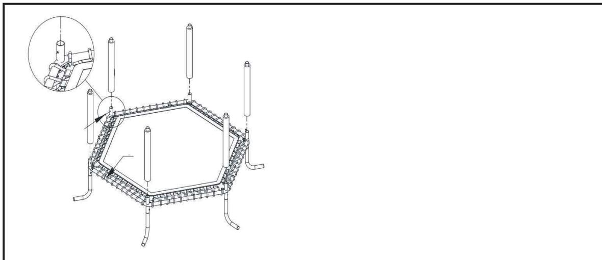
Fije la red desde arriba hacia abajo a la rejilla principal con la hebilla sujetadora de red que está en la cabeza esférica, luego ate la banda elástica de abajo al tubo de abajo.
