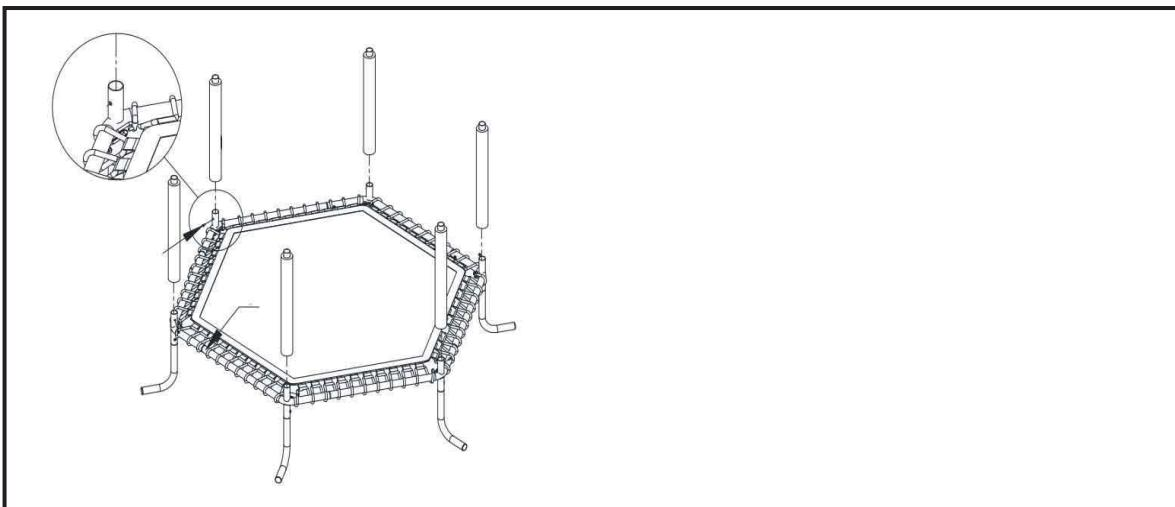
5. Fixez le filet du haut vers le bas au cadre principal avec la boucle de fixation du filet sur la tête de balle et attachez l'élastique du bas au tuyau du bas.
