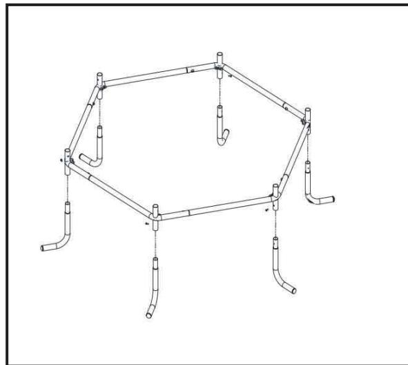
2. Installez le tube de la jambe en "L" dans le support principal à tour de rôle et serrez les vis avec un outil.
