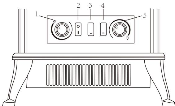
1. Bouton de contrôle du thermostat ( RÉGLAGE DE LA TEMPÉRATURE )- Réglage pour maintenir la température ambiante.
