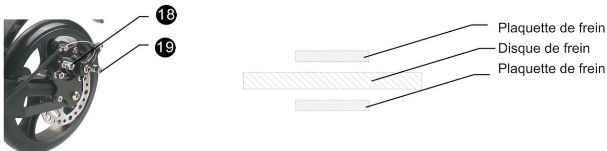
La plaquette de frein et le disque de frein doivent être ajustés régulièrement, comme montré sur la figure ci-dessus. Si vous laissez les plaquettes et les disques de frein non réglés pendant une longue période, leur durée de vie sera réduite et ils deviendront un danger pour la sécurité.
