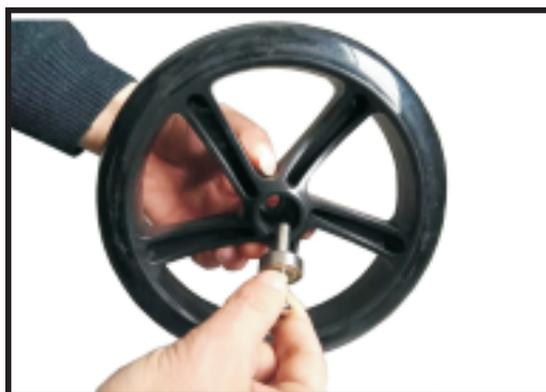
Vérifiez régulièrement l'état des roulements et des roues et remplacez-les si nécessaire.
