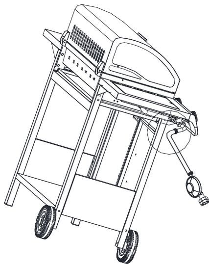
Inserire il tubo nel connettore della griglia
