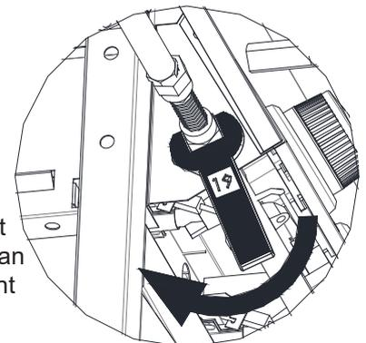
Ziehen Sie die Schraube mit einem Schraubenschlüssel an (Schraubenschlüssel ist nicht im Lieferumfang enthalten)
