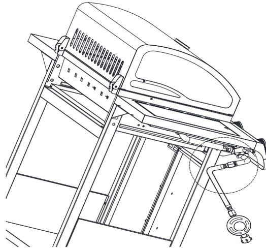
Ziehen Sie die Schraube mit einem Schraubenschlüssel an
