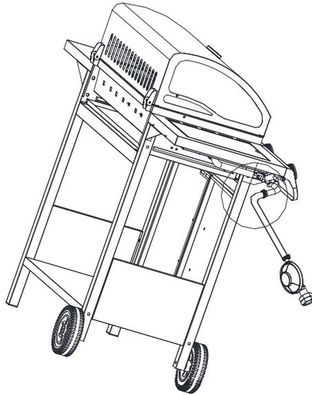
Inserire il tubo nel connettore della griglia
