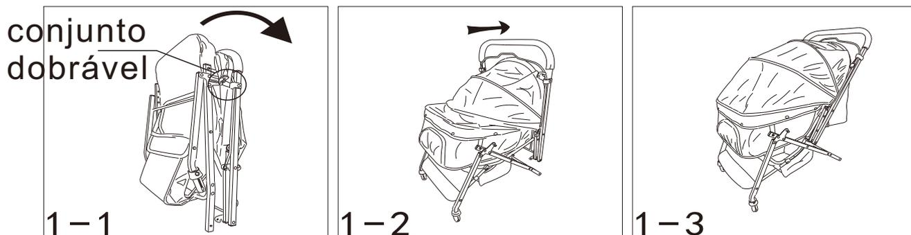
\* Abrir a caixa, retirar a estrutura e todos os tipos de peças do saco de PE, e depois soltar os conjuntos para fixar a estrutura. puxar a pega para cima. (figura 1-1)
