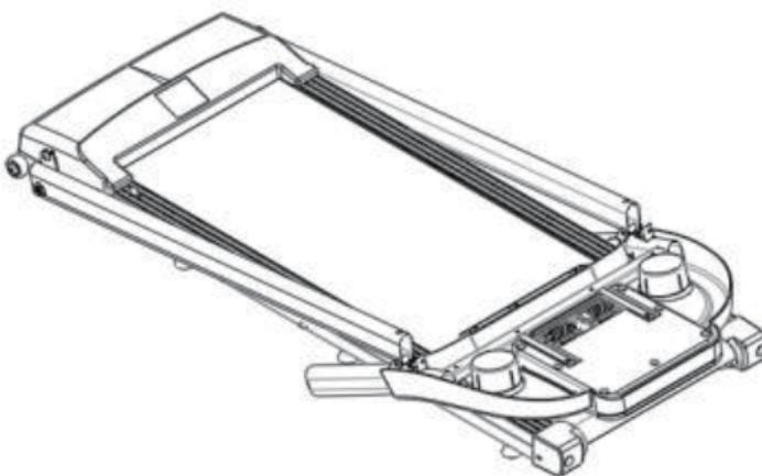
Paso 2: Tire de la columna en la dirección de la flecha y asegúrela al marco principal con pernos hexagonales de cabeza semicircular D#M8\*16 y arandelas planas E#M8.
