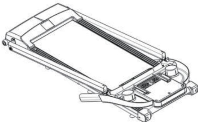
Passo 2: Puxar a coluna na direção da seta e fixá-la à estrutura principal com parafusos hexagonais de cabeça semi-redonda D#M8\*16 e arruelas planas E#M8.
