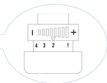
Note : Réglez le bouton de contrôle de la tension à 1 pour assurer une longueur de câble suffisante pour connecter les fils de contrôle de la tension (n° 72 et 73).
