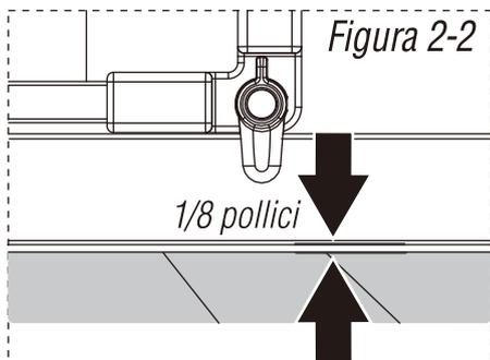
Posizionare il cancello nel varco scelto con la parte inferiore rivolta al pavimento. La distanza tra la parte inferiore del cancello e il pavimento dovrebbe essere inferiore a 1/8 pollici (Figura 2-2).
