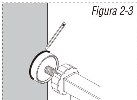
Una volta che siete soddisfatti del posizionamento del cancello, avvitare i mandrini filettati fino a stringere i piedini in gomma sulla superficie del varco assicurandosi che siano a livello (Figura 2-3). Quindi rimuovere il cancello dal varco. Avvitare le 4 ventose a muro usando le viti (Figura 2-4) o fissare le 4 ventose utilizzando gli adesivi in dotazione (Figura 2-5).
