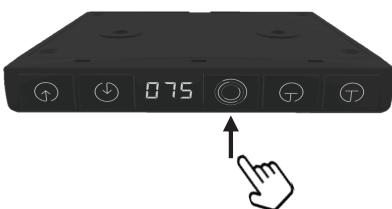
Quando la luce lampeggia, la scrivania si sposta lentamente di 12 cm in 3 minuti. Successivamente, si ferma per 2 minuti e poi si abbassa lentamente di 12 cm in 3 minuti. Dopo 2 minuti, i movimenti si ripetono.
