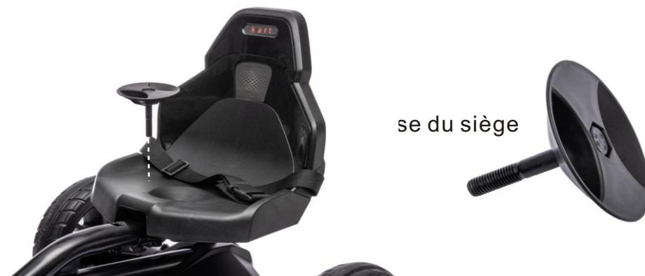
Placer le siège sur la carrosserie comme indiqué sur l'illustration et le fixer à l'aide d'un fixateur de siège.
