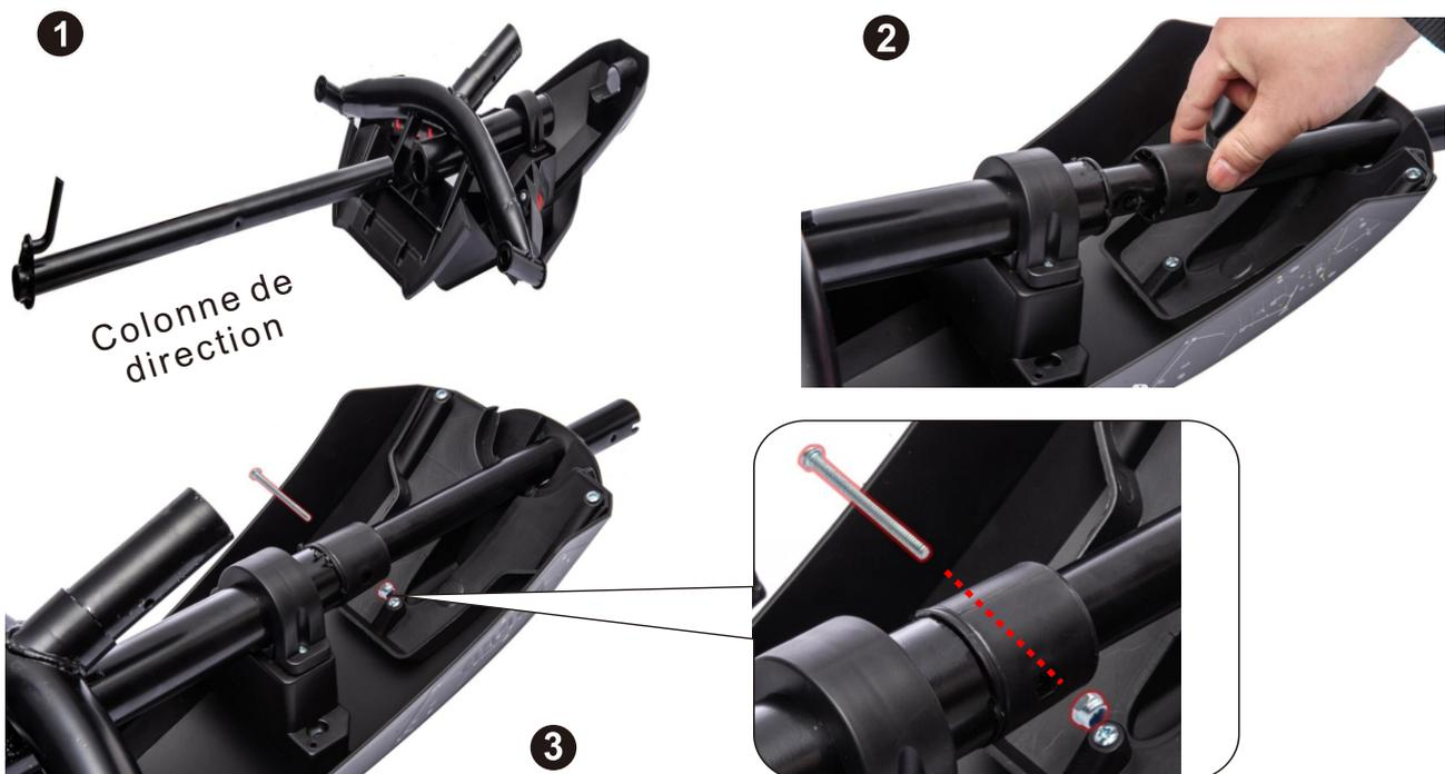
1. Insérer la colonne de direction sous l'assemblage avant, comme indiqué sur l'image.
