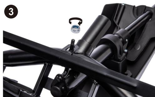
1. Placer l'essieu de direction sous l'assemblage avant, comme indiqué sur l'image.
