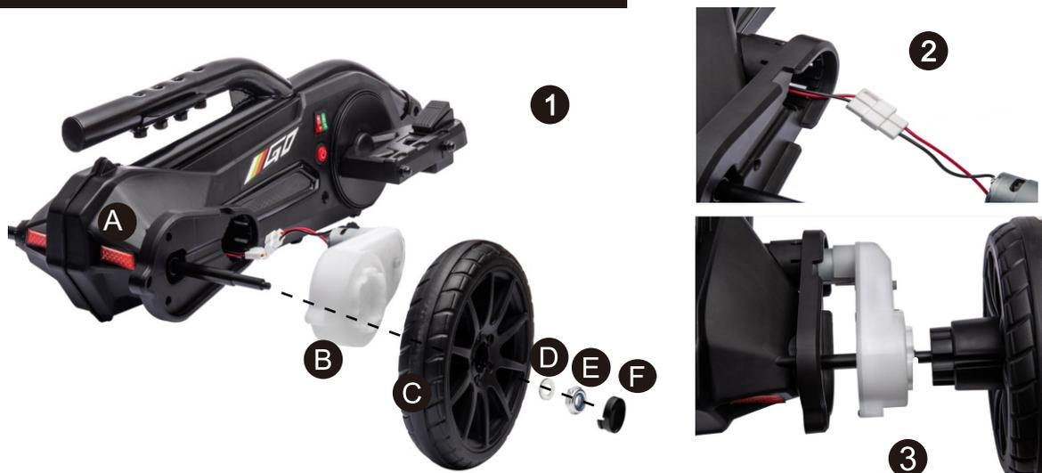
A. Corps principal B. Boîte de vitesses C. Roue D. Rondelle E. Écrou
