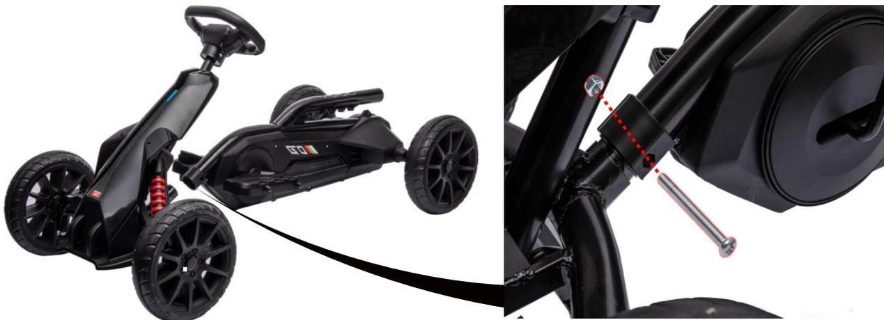
Connecter la composante avant à la carrosserie comme indiqué sur l'image et le fixer à l'aide d'un écrou et de vis.
