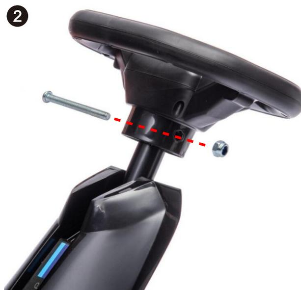
1. Placer le volant sur la colonne comme indiqué sur l'image, en veillant à ce que tous les trous soient alignés.
