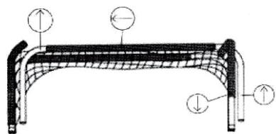
Sortez le but. Déplacez le manchon en filet du côté gauche vers la droite, insérez le côté supérieur gauche du but dans le cadre inférieur et fixez-le par la fixation de la charnière.
