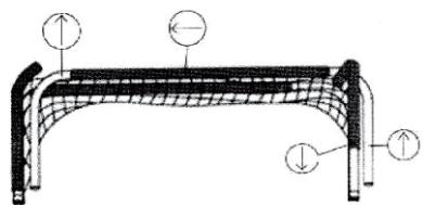
Nehmen Sie das Tor heraus. Bitte bewegen Sie die Netzhülle von der linken Seite nach rechts. Dann führen Sie bitte die linke obere Seite des Tores in den unteren Rahmen ein und befestigen Sie es durch die Befestigung des Scharniers.
