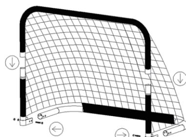
A rede deve ser colocada uniformemente em torno da circunferência da baliza. Segurar a estrutura inferior à moldura superior em ângulos rectos. Posicionar o baliza.
