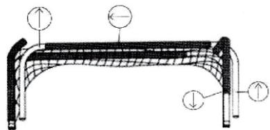
Saque la portería. Mueva la red desde el lado izquierdo hacia la derecha. Inserte el lado superior izquierdo de la portería en el marco inferior y fíjela mediante la bisagra. Luego mueva la red al otro lado, y fije la parte derecha restante al marco inferior y ajústela de la misma manera.
