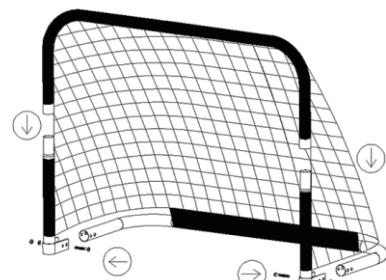
Die Netzhülle sollte gleichmäßig über den gesamten Torumfang gelegt werden und den unteren Rahmen senkrecht zum oberen Rahmen halten. Jetzt können Sie das Tor aufstellen.
