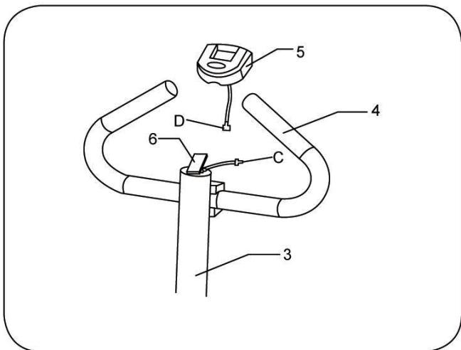
Verbinden Sie den Stecker C mit dem Messgerätestecker D und befestigen Sie das Messgerät auf dem Messgerätehalter.
