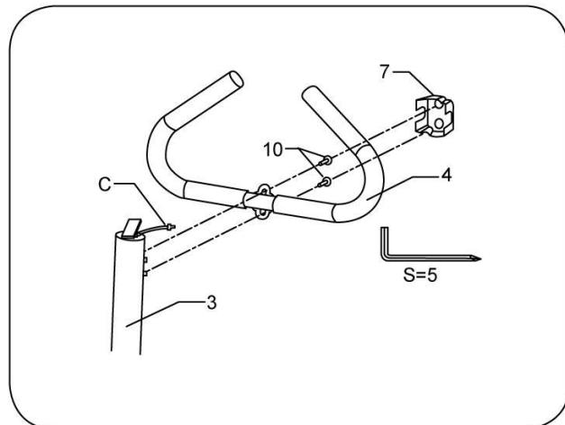
Tire del conector C a través del soporte del medidor del tubo superior. Fije y sujeté el asa al tubo superior con un perno y, a continuación, coloque la tapa, como se muestra a la izquierda.
