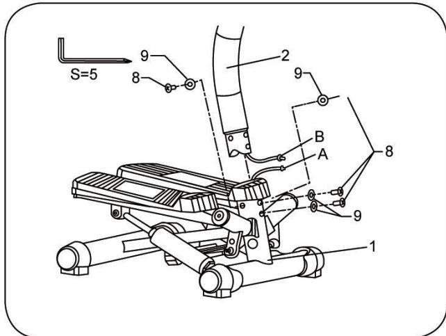
Stellen Sie das Basisgerät auf eine ebene Fläche. Führen Sie Kabel B in das untere Rohr ein, verbinden Sie Kabel A und B miteinander und setzen Sie dann das untere Rohr in das Basisgerät ein und befestigen Sie es mit einer Schraube, wie linksseitig dargestellt.
