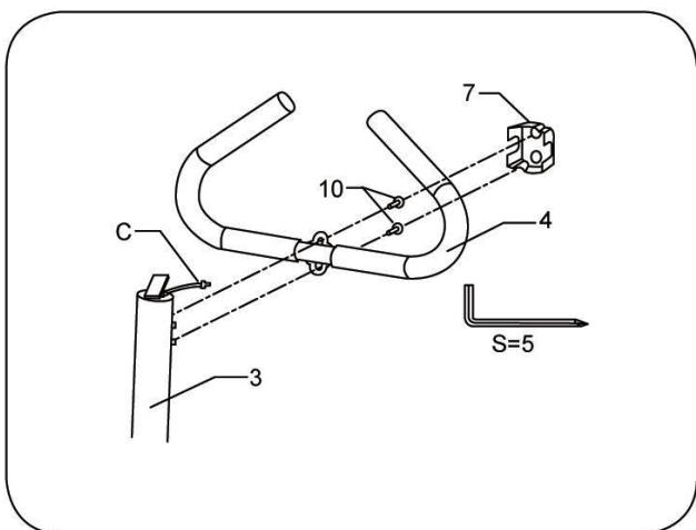
Tirez le connecteur C à travers le porte-mètre du tube supérieur. Fixez et attachez la poignée au tube supérieur avec un boulon, puis mettez le couvercle, comme indiqué à gauche.
