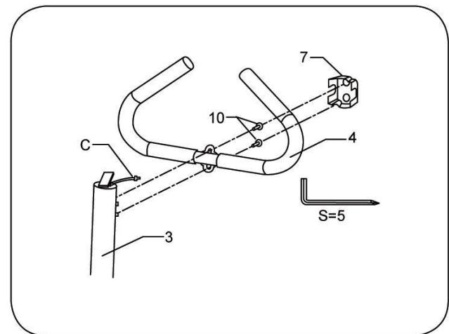
Ziehen Sie den Stecker C durch den Messgerätehalter des oberen Rohrs. Befestigen Sie den Griff mit einer Schraube am oberen Rohr und setzen Sie dann die Abdeckung auf, wie linksseitig dargestellt.
