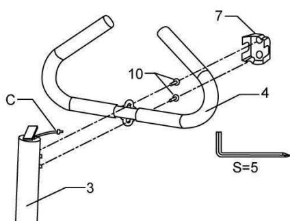
Puxar o conector C através do suporte do ecrã do tubo superior. Fixar e prender o guiador ao tubo superior com um parafuso e, em seguida, coloque a tampa, como se mostra à esquerda.
