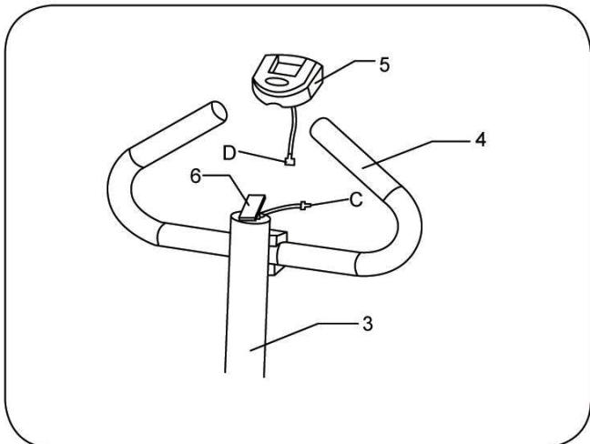
Collegare il connettore C e la spina dello strumento D, e poi fissare il metro sul portametro.
