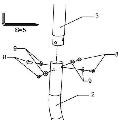
Verifique que os cabos estejam bem conectados dentro do tubo superior, em seguida fixe o tubo superior com o tubo inferior com um parafuso, como indicado à esquerda, como se mostra à esquerda.
