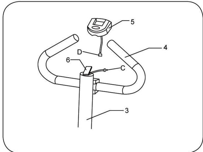
Connectez le connecteur C et la fiche D du compteur, puis fixez le compteur sur le support du compteur.
