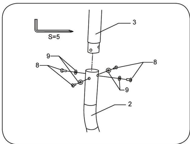
Tirez le câble B à travers le tube supérieur, qui sera ensuite fixé au tube inférieur avec un boulon, comme indiqué sur la gauche.
