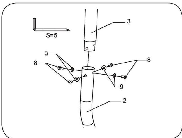
Tirare il cavo B attraverso il tubo superiore il quale viene poi inserito e fissato al tubo inferiore con un bullone, come mostrato a sinistra.
