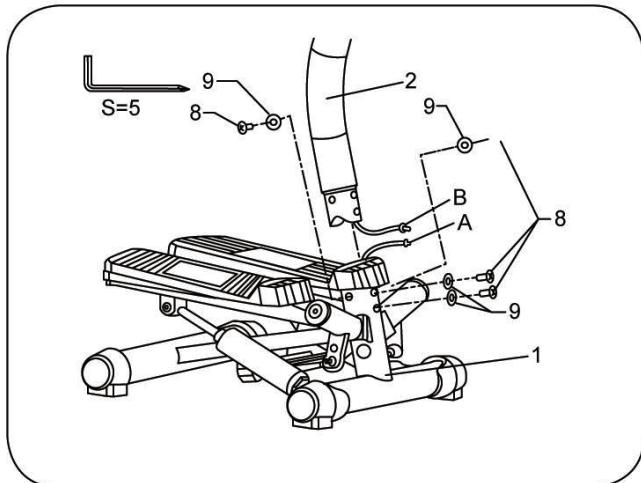
Posizionare il telaio su una superficie piana. Inserire il cavo B nel tubo inferiore e collegare il cavo A e il cavo B insieme, e poi inserire il tubo inferiore nel telaio e fissarlo con un bullone, come mostrato a sinistra.
