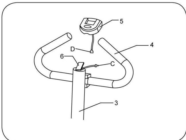
Conecte el conector C y la clavija del medidor D y, a continuación, fije el medidor en el soporte.
