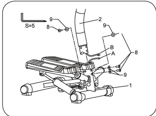
Placez la machine de base sur une surface plane. Insérez le câble B dans le tube inférieur, et connectez les câbles A et B ensemble, puis insérez le tube inférieur dans la machine de base et fixez-le avec un boulon, comme illustré à gauche.
