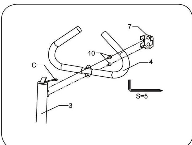
Tirare il connettore C attraverso il portametro del tubo superiore. Fissare e serrare il manubrio al tubo superiore con un bullone e poi montare il coperchio, come mostrato a sinistra.
