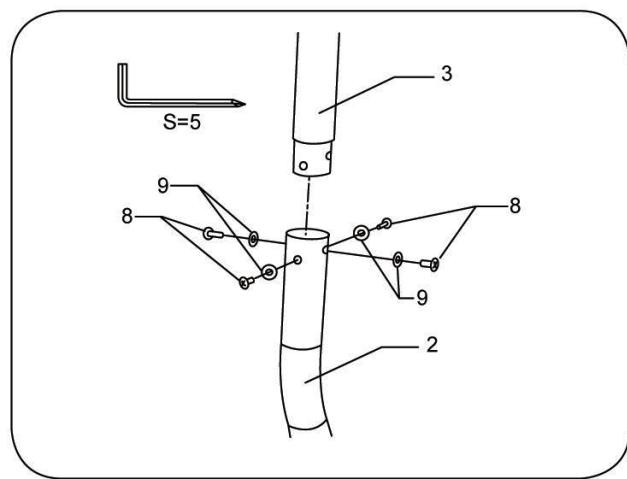
Ziehen Sie Kabel B durch das obere Rohr, das dann mit einer Schraube am unteren Rohr befestigt wird (siehe Abbildung links).
