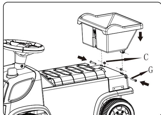
Setzen Sie die Kippmulde auf das Heck des Fahrzeugs und schrauben Sie sie fest. (M5-Mutter x 2 & 5 x 40-Schraube x 2)
