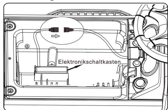
Öffnen Sie den Sitz, schließen Sie die Kabelzuführung am Batteriefach an, öffnen Sie das Batteriefach, legen Sie die Trockenbatterie ein und schließen Sie den Sitz. (3 X 1,5 V #7 Trockenzelle)
