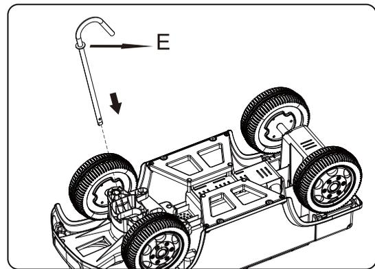
Stecken Sie die Lenkstange mit einer Unterlegscheibe durch die Karosserie. (10 x 20 x 2 Unterlegscheibe x 1)
