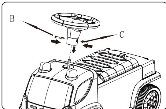
Stecken Sie den Lenker in die Lenkstange und schrauben Sie es fest. (M5-Mutter x 1 & 5 x 38-Schraube x 1)
