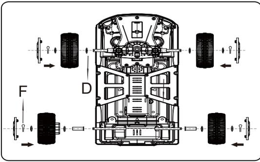
Drehen Sie die Karosserie um, setzen Sie die Hinterachse in die Karosserie ein, setzen Sie die Achsmanschette und die Dichtung ein, setzen Sie das Antriebsrad auf der linken Seite ein, setzen Sie das normale Rad auf der rechten Seite ein, setzen Sie die Dichtung ein, verriegeln Sie mit dem Öffnungsstift, decken Sie die Radabdeckung ab. Das Vorderrad funktioniert auf die gleiche Weise. (10 X 18 X 1 Unterlegscheibe x 8 & 2,5 X 3 Splint x 4)
