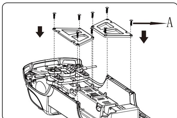
Drehen Sie die Karosserie um, drücken Sie die Seitenstütze auf die Karosserie und befestigen Sie sie mit Schrauben. (4 X 10 Blechschrauben x 8)
