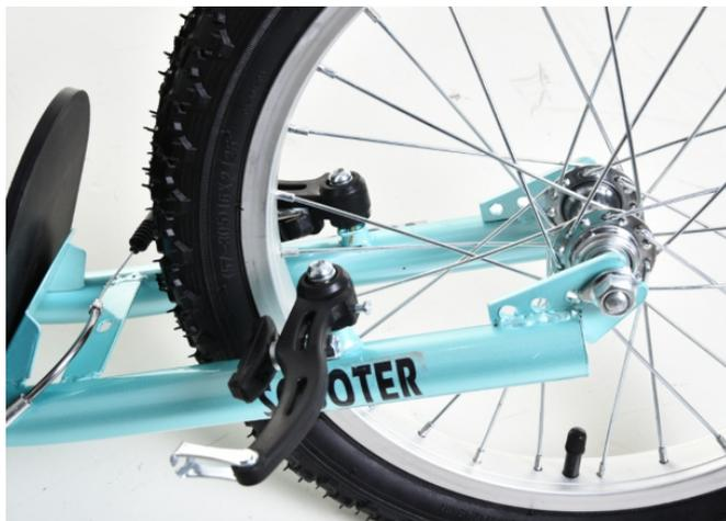
Remarque: Pendant l'installation de la roue, assurez-vous que le bord supérieur de la plaquette de frein est égal avec le bord supérieur de la jante de la roue
