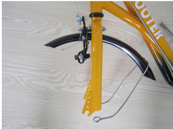
3 : Insérez la vis du frein avant dans le trou de l'élévateur de la fourche avant.
