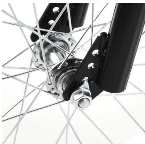
Veillez ne pas dévisser les deux côtés des écrous (c). Le jeu entre les roulements a été ajusté en usine.
