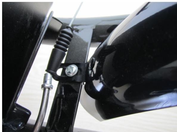
1. La pièce de fixation du garde-boue arrière est installée dans le trou du cadre, serrez la vis.
