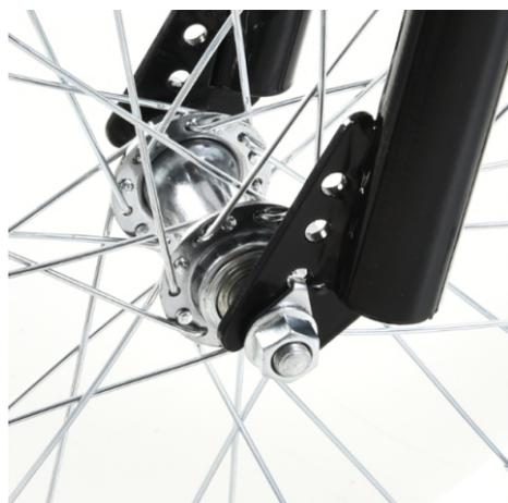
Veuillez ne pas dévisser les deux côtés des écrous (c). Le jeu entre les roulements a été ajusté en usine.
