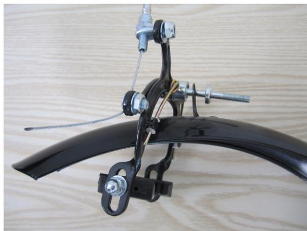
1. La pièce de fixation du garde-boue avant est insérée dans la vis du frein avant.
