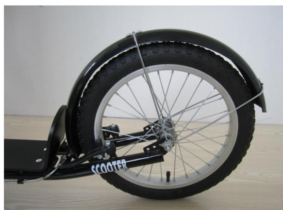
4. Installez le support de garde-boue dans l'essieu arrière et serrez l'écrou extérieur pour fixer le support de garde-boue.
