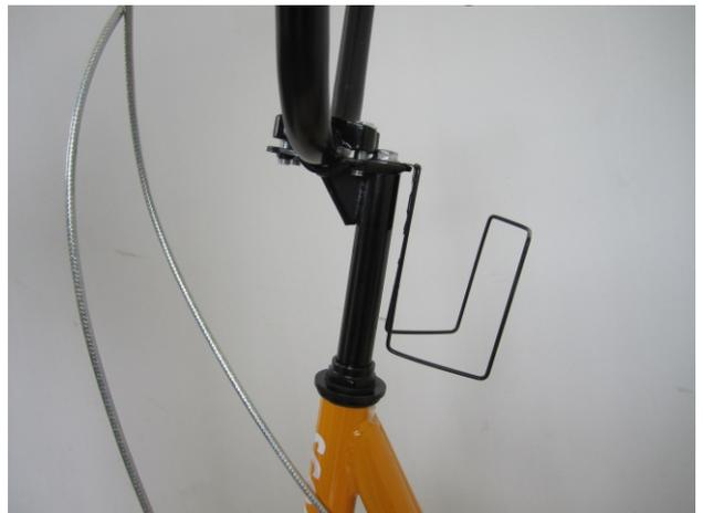
Desserrez l'écrou, insérez le panier à bouteilles et serrez-le fermement.
