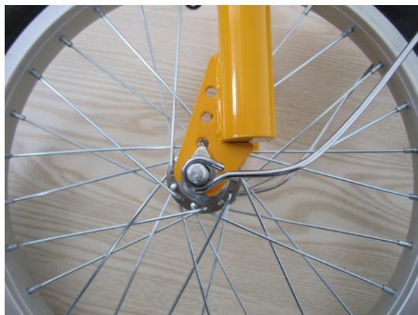
5 : Insérez l'axe de la roue avant dans la rainure de la fourche avant, puis insérez le crochet de sécurité.
