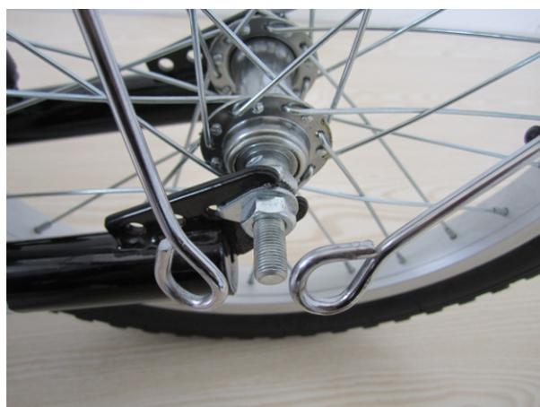
2. Insérer l'axe de la roue arrière dans la rainure de la fourche arrière, puis le crochet de sécurité.
