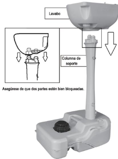
**3** Inserte el grifo en el tubo transparente y fíjelo en el lavabo, luego fije el tubo con el tanque de base y la columna de soporte.
