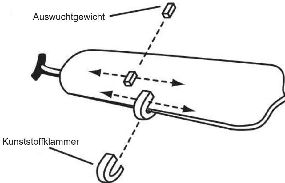
Hinweis: Prüfen Sie vor der Verwendung dieser Ausrüstung Ihren Ventilator, um sicherzustellen, dass er korrekt montiert ist und alle Schrauben zur Einstellung der Flügel fest angezogen sind. Warnung: Stellen Sie bei der Verwendung der Anti-Schwingausstattung sicher, dass die Gewichte und der Schwingungsclip korrekt an den Flügeln eingehängt sind. Wenn der Clip und die Gewichte nicht richtig befestigt sind, kann es zu einem Unfall kommen.
