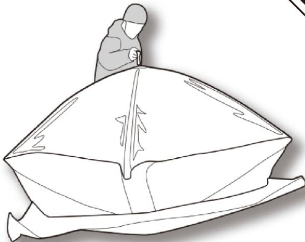
Tire firmemente hacia arriba de la correa en el cubo central del techo hasta que salte. Gire ligeramente el techo para que las esquinas de la parte superior e inferior queden alineadas.
