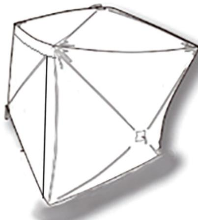
Levantando o teto do abrigo, puxe para fora o cubo central de uma das paredes.
