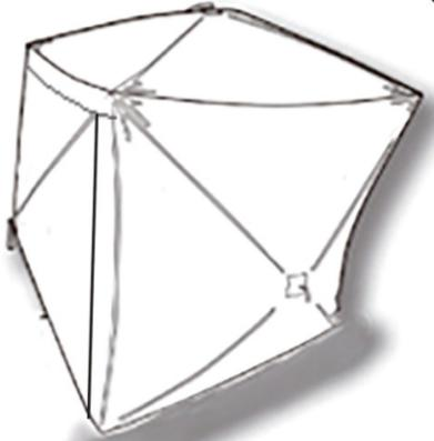
Sollevando il tetto del rifugio, tirare verso l'esterno il mozzo centrale di una delle pareti. Continuare a girare intorno all'intero rifugio, tirando ogni mozzo della parete fino a quando tutte le pareti non sono state montate.
