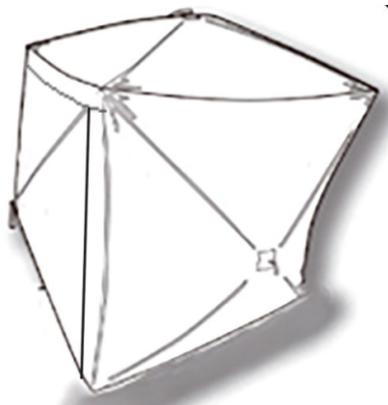
Heben Sie das Dach der Unterkunft an und ziehen Sie an der mittleren Nabe einer der Wände nach außen. Fahren Sie um die gesamte Unterkunft herum fort und ziehen Sie an jeder Wandnabe, bis alle Wände aufgestellt sind.
