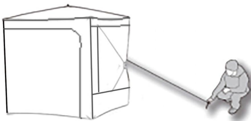
Trouvez le côté de l'auberge de pêche qui fait face au vent et attachez l'une des sangles fournies aux moyeux centraux de ce mur. Tendez la sangle face au vent et fixez-la à la glace avec le(s) pic(s) à glace restant(s).
