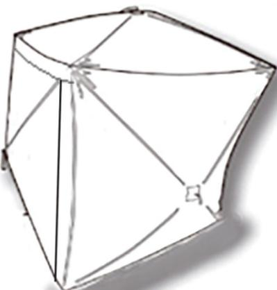
En soulevant le toit de l'abri, tirez vers l'extérieur sur le moyeu central de l'un des murs. Continuez à faire le tour de l'abri, en tirant sur le moyeu de chaque mur jusqu'à ce que tous les murs soient en place.
