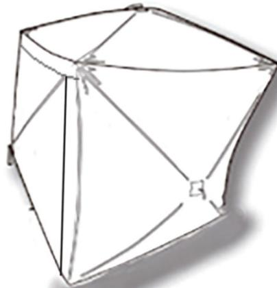
Levantando el techo del refugio, tire hacia fuera del centro de una de las paredes. Continúe alrededor de todo el refugio, tirando de cada cubo de la pared hasta que todas las paredes se establecen.
