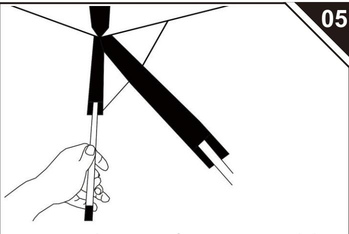
La tige extérieure en fibre de verre a été ouverte et placée dans le ruban à l'intérieur de la porte et attachée avec un tissu au milieu. Les trous de maïs aux quatre coins du fond intérieur sont fixés avec des clous.
