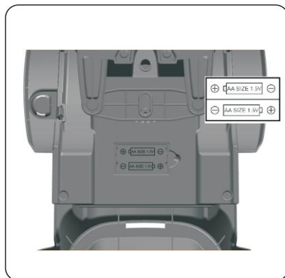
Gire el cuerpo del tractor y localice el compartimento de las pilas. Afloje el tornillo con un destornillador (no incluido). Coloque 2 pilas AA en el compartimento de las pilas y apriete el tornillo con un destornillador (no incluido).
