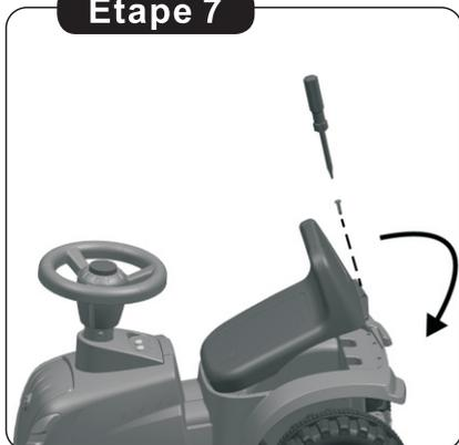
7. Assembler le siège, serrer avec une vis noire à l'aide d'un tournevis (non inclus).
