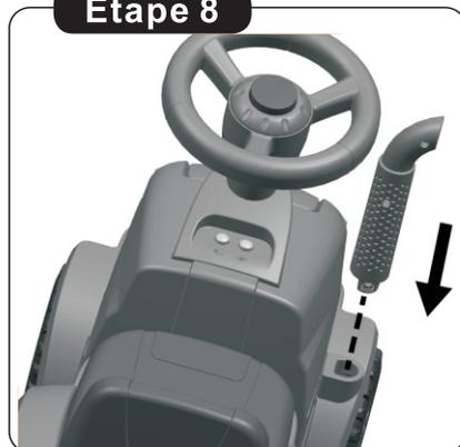
8. Insérez le tuyau d'échappement, assurez-vous que le tuyau d'échappement est complètement positionné.
