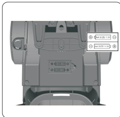
Capovolgere il corpo del trattore e trovare il vano della batteria. Allentare la vite con un cacciavite (non incluso). Sostituire con 2 batterie AA nel vano, e poi serrare la vite con un cacciavite (non incluso).
