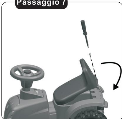
7. Montare il sedile, stringere con una vite nera da un cacciavite (non incluso).
