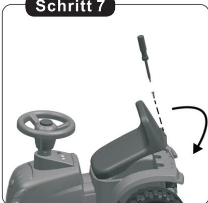
7. Montieren Sie den Sitz, ziehen Sie die schwarze Schraube mit einem Schraubendreher fest (nicht im Lieferumfang enthalten).
