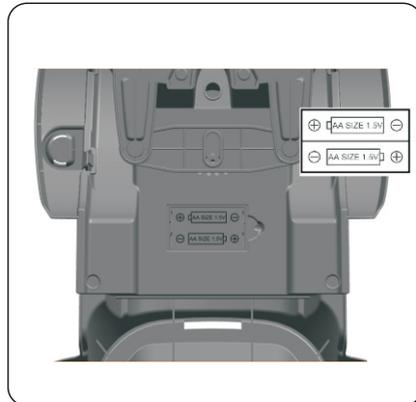
Drehen Sie die Traktorkarosserie um, und suchen Sie das Batteriefach. Lösen Sie die Schraube mit einem Schraubendreher (nicht im Lieferumfang enthalten), legen Sie 2 AA-Batterien in das Batteriefach und ziehen Sie die Schraube mit einem Schraubendreher fest (nicht im Lieferumfang enthalten).
