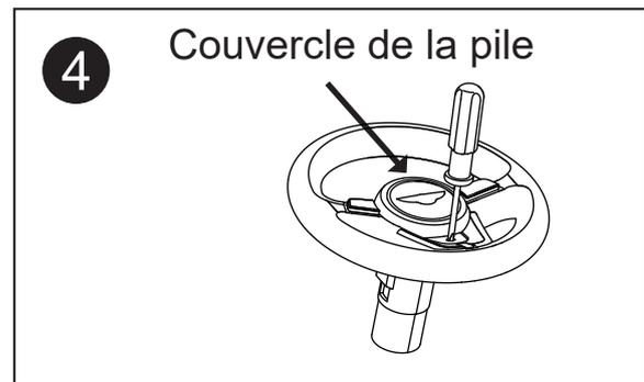
Dévissez le couvercle de la pile avec un tournevis cruciforme.
