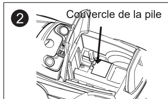
Dévissez le couvercle de la pile avec un tournevis cruciforme.
