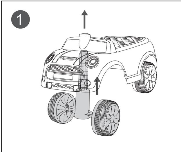
1 Laissez la roue avant traverser le corps de la voiture, comme indiqué sur la figure.
