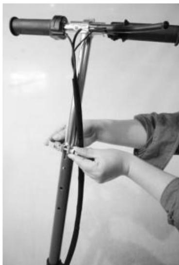
3. Bloccare e stringere completamente la leva di chiusura nel tubo frontale.
