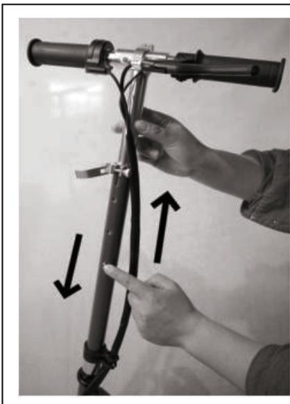
2. Presione el pasador de seguridad y levante o baje la barra en T para ajustar la altura.
