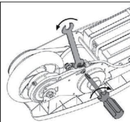
8. Resserrez le boulon du bras de frein avec un tournevis Phillips et une clé de 8 mm.
