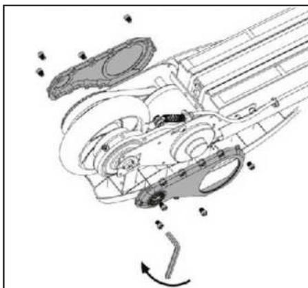
10. Reinstallare i coperchi laterali con una chiave a brugola da 4 mm. Non serrare eccessivamente le viti.
