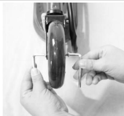
6. Utilizzare la chiave esagonale da 2 mm per inserire la vite dell'asse e fissarla con una chiave esagonale.
