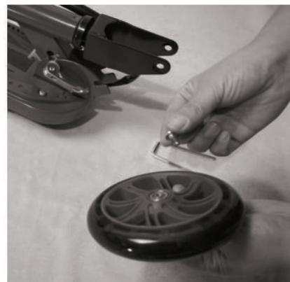
3. Retirez la vis de l'axe dans la roue avant.
