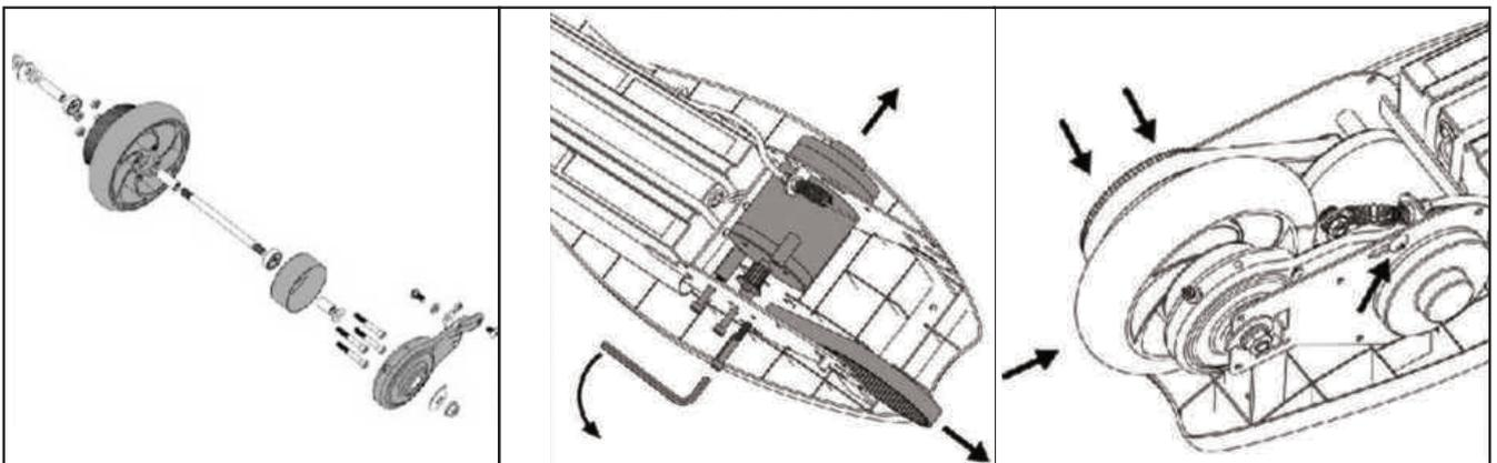
4. Tome nota de la ubicación de todo el equipo de la rueda trasera y asegúrese de volver a instalar todos los elementos correctamente.
