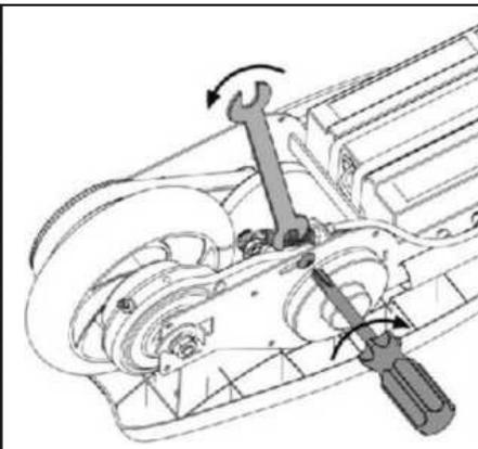
8. Vuelva a apretar el brazo del freno atornillar con una phillips destornillador y llave de 8 mm.
