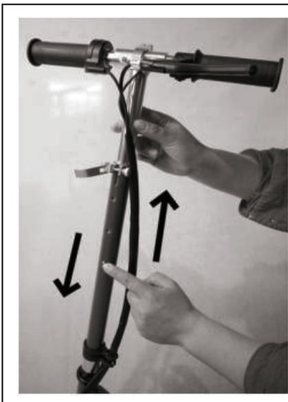
2. Premere la testina di blocco e sollevare o abbassare la barra a T per regolare l'altezza.
