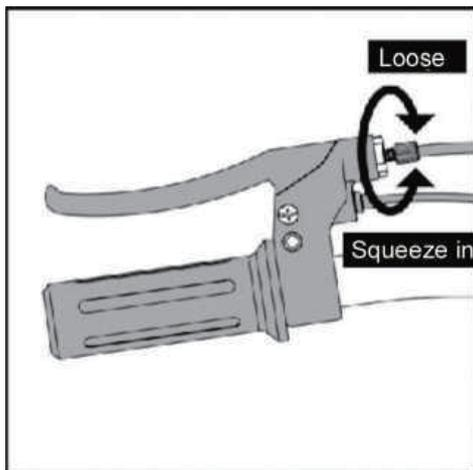
1. Pour ajuster le câble de frein, tournez le tambour de réglage sur le levier de frein dans le sens des aiguilles d'une montre (pour desserrer) ou dans le sens inverse (pour serrer). Ajustez le tambour par petits incréments jusqu'à l'ajustement désiré. Si le frein nécessite encore un ajustement, passez à l'étape suivante.
