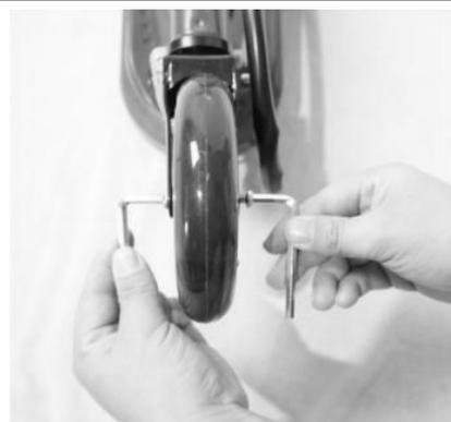
6. Utilizar a chave hexagonal de 2\*5mm para inserir o parafuso do eixo e fixar com uma chave hexagonal.
