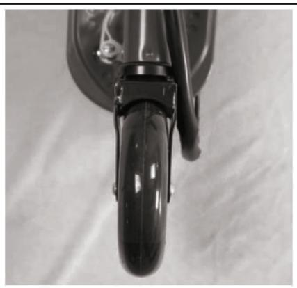
7. Tournez l'autre clé hexagonale pour serrer la vis avec l'axe et la fourche avant.
