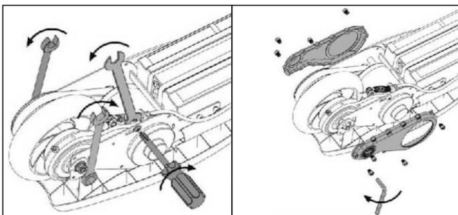
4. Asegúrese de que la rueda esté alineada en el marco y apriete las dos tuercas del eje con una llave de 13 mm. Vuelva a apretar el brazo del freno con un destornillador Phillips y una llave de 8 mm.
