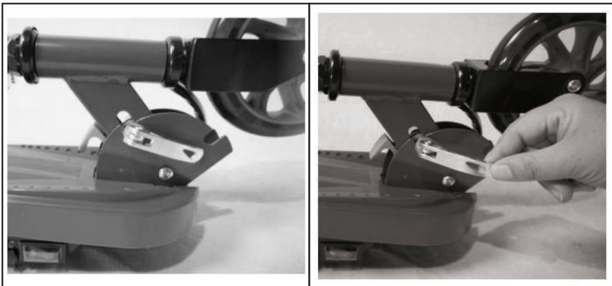
1. Sganciare la leva di chiusura del meccanismo di bloccaggio
