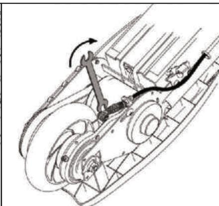
9. Resserrez légèrement l'écrou du câble de frein avec une clé de 10 mm.
