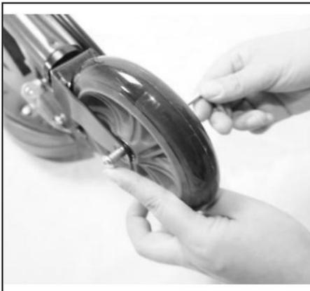
4. Utilice una llave hexagonal de 1 x 5 mm para guiar e insertar el eje en el orificio de la horquilla delantera.
