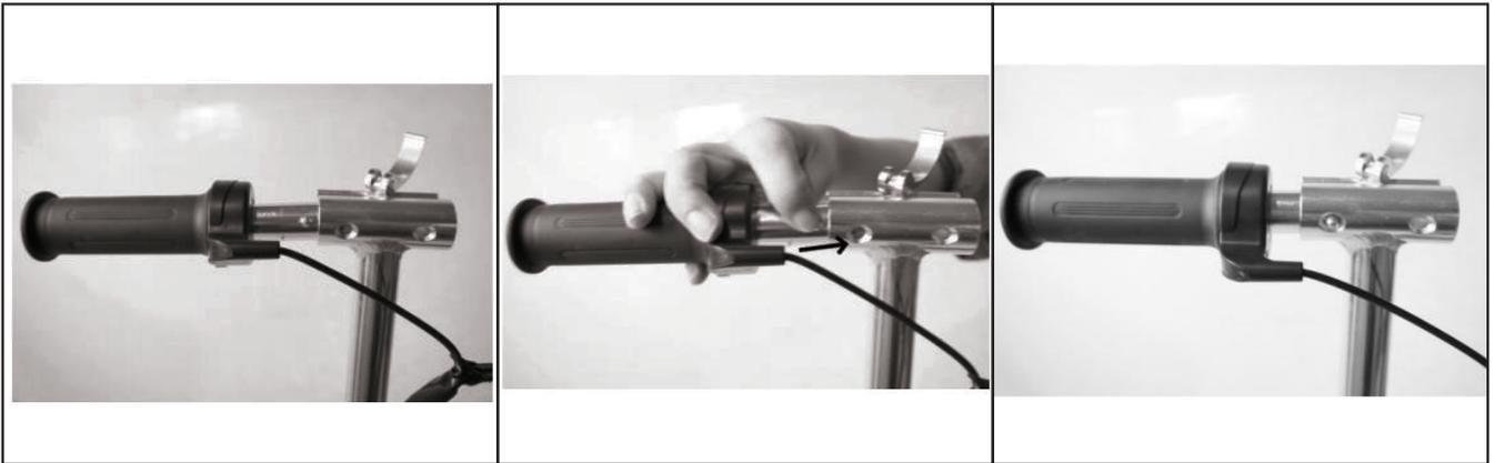
2. Inserte el manillar derecho del acelerador y use el dedo para presionar el pasador de presión para insertarlo y fijarlo con el orificio en la barra en T del manillar.
