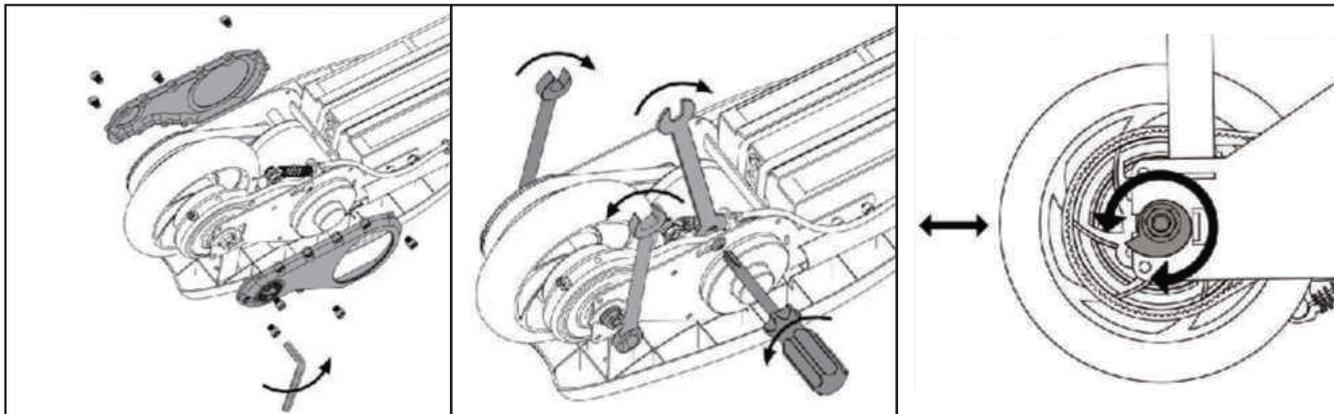
1. À l'aide d'une clé hexagonale de 4 mm, retirez les 3 vis du couvercle de protection de chaque côté de la trottinette.
