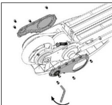
10. Reinstalar as tampas laterais com uma chave Allen de 4mm. Não apertar demasiado os parafusos.
