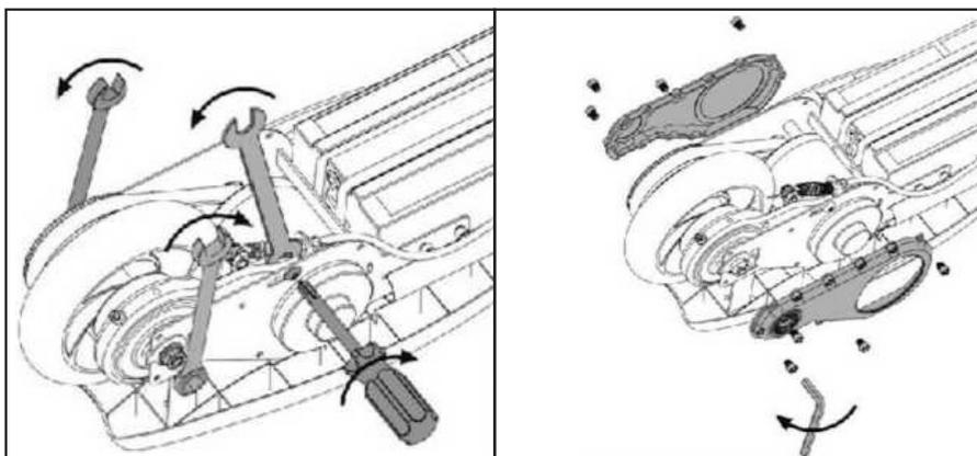
4. Certifique-se de que a roda está alinhada na estrutura e aperte as porcas de dois eixos com uma chave de parafusos de 13mm para apertar novamente o braço do travão com uma chave de parafusos Phillips e uma chave de parafusos 8mm.
