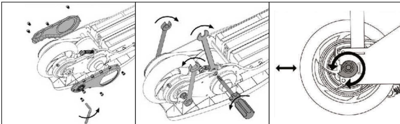
1. Com uma chave hexagonal de 4mm retirar os 3 parafusos da tampa protectora em ambos os lados da trotinete.
