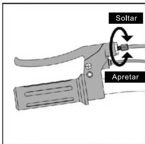
1. Para ajustar el alambre del cable del freno, gire el tambor de ajuste en la palanca del freno hacia la derecha (para aflojar) o hacia la izquierda (para apretar). Ajuste el tambor en pequeños incrementos a la configuración deseada. Si el freno aún requiere ajuste, continúe con el siguiente paso.
