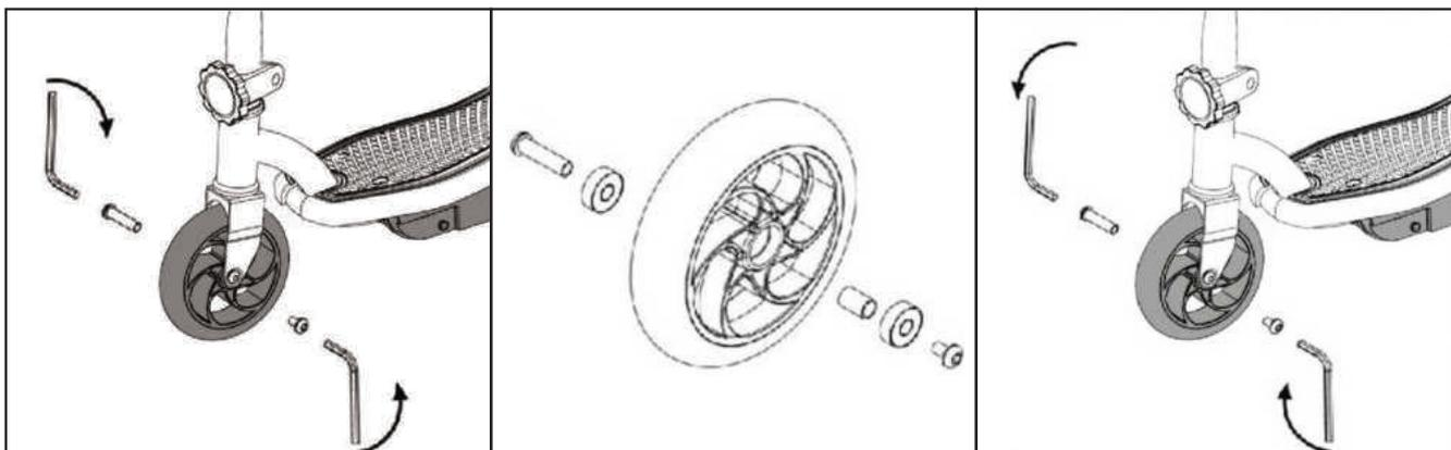
1. Con dos llaves hexagonales de 5 mm, afloje y extraiga el eje delantero girando las llaves hacia la izquierda.
