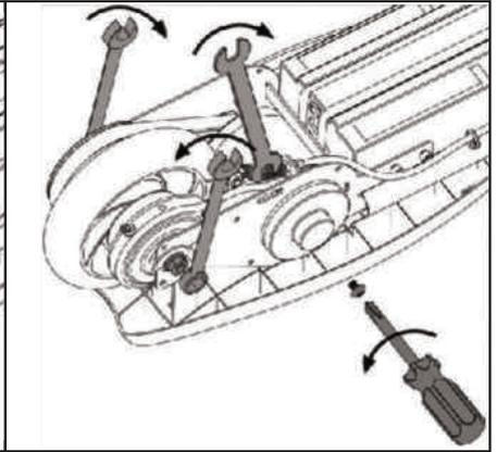
3. Rimuovere il braccio del freno con un cacciavite a croce e una chiave da 8 mm. Utilizzare due chiavi da 13 mm a allentare i dadi della ruota dell'asse posteriore e le rondelle di regolazione e fare scorrere fuori la cinghia dalla puleggia della ruota posteriore. Tirare la ruota verso la parte posteriore del telaio.
