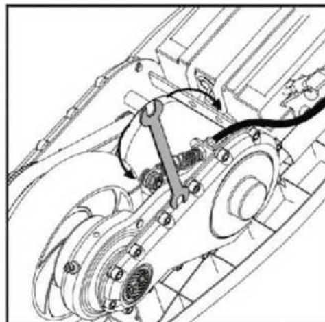
2. Se o cabo do travão ainda estiver demasiado apertado, usar uma chave de 10mm para apertar o cabo do travão para um ajuste adicional no cabo. Certifique-se de que a porca de 10mm é apertada após o ajuste.
