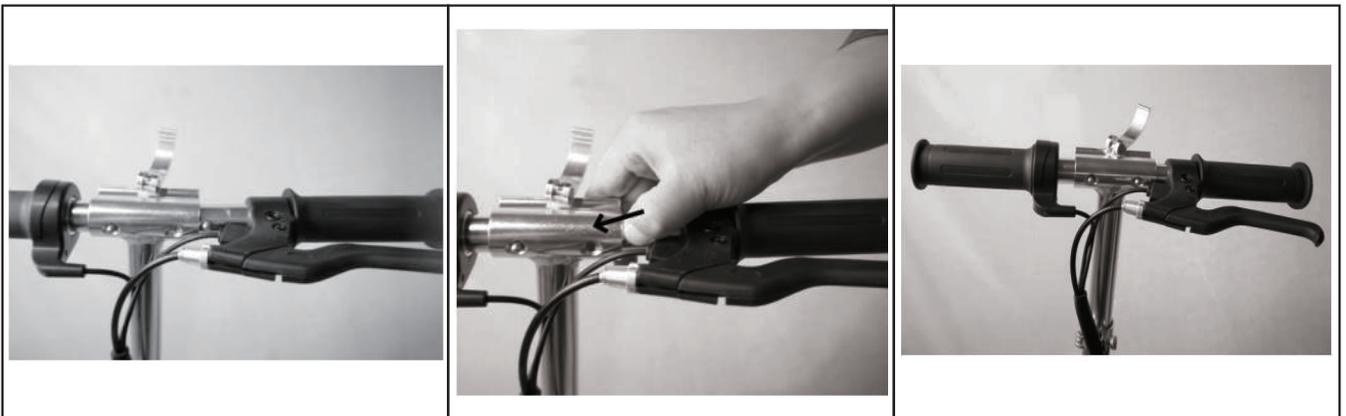
3. Insérez le guidon gauche du frein à main et utilisez le doigt pour appuyer sur la goupille à pression pour l'insérer et la fixer dans le trou de la barre en T du guidon.
