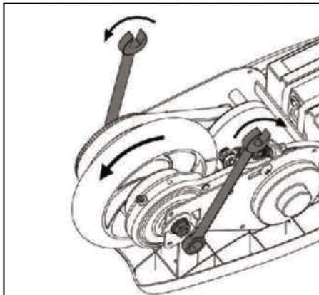
7. Asegúrese de que las arandelas de ajuste estén colocadas correctamente contra el bastidor. Después de apretar las tuercas del eje con una llave de 13 mm, compruebe la alineación de las ruedas y la banda de rodadura de la correa girando la rueda con la mano en sentido contrario a las agujas del reloj. Es posible que deba ajustar las arandelas para alinear la correa.
