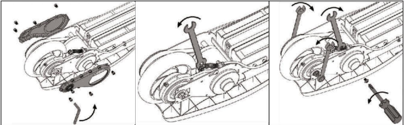
1. Con una llave hexagonal de 4 mm, retire los 4 pernos de la cubierta del eje trasero en ambos lados del scooter. (Solo para scooter con cubiertas).
