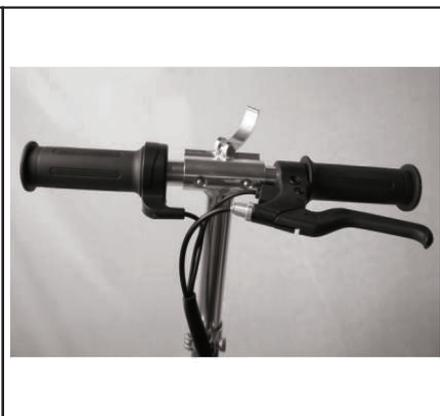
3. Inserire il manubrio sinistro del freno a mano e premere con il dito la testina di blocco per inserirla e fissarla con il foro nella barra a T del manubrio.
