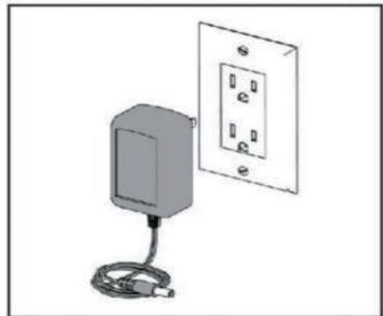
2. Branchez le chargeur dans une prise murale. La lumière sur le boîtier du chargeur s'allumera. La lumière rouge indique que la batterie est en charge. La lumière verte indique que la batterie est complètement chargée.
