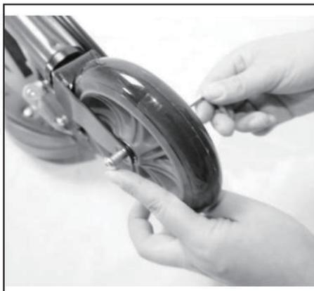
4. Utilisez une clé hexagonale de 5mm pour guider et insérer l'axe dans le trou de la fourche avant.
