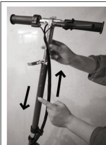
2. Premir o pino de pressão e levantar ou baixar a barra em T para ajustar a altura.
