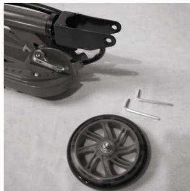
2. Estrarre la ruota anteriore e la chiave esagonale da 2\*5 mm per il montaggio.
