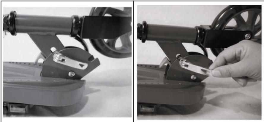
1. Relâchez le verrou du mécanisme de verrouillage.
