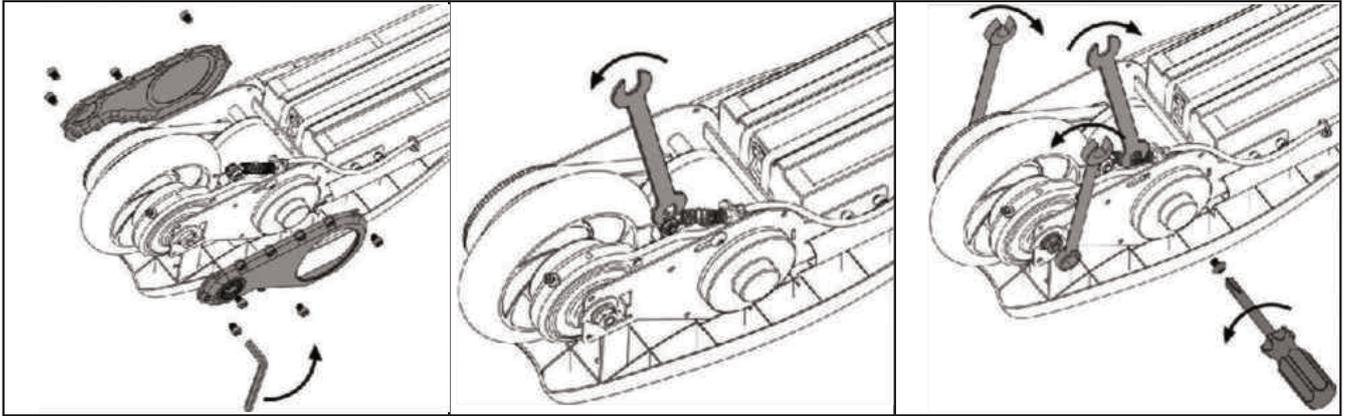
1. À l'aide d'une clé hexagonale de 4 mm, retirez les 4 boulons du couvercle de l'essieu arrière des deux côtés de la trottinette. (Uniquement pour les scooters avec couvercles.)
