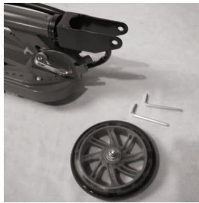
2. Saque la rueda delantera y la llave hexagonal de 2x5 mm para ensamblar.
