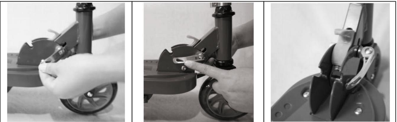
4. Rodar o mecanismo de bloqueio e depois apertá-lo completamente e fechá-lo bem antes de montar.
