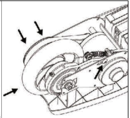
6. Installare la ruota di scorta nel telaio e far scorrere nuovamente la cinghia sulla puleggia. Non serrare ancora i dadi dell'asse. Installare il sistema frenante a leva, non ancora regolato,
