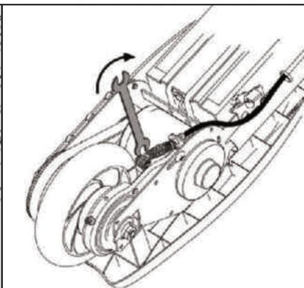
9. Voltar a apertar o cabo do travão porca ligeiramente com uma 10mm chave inglesa.
