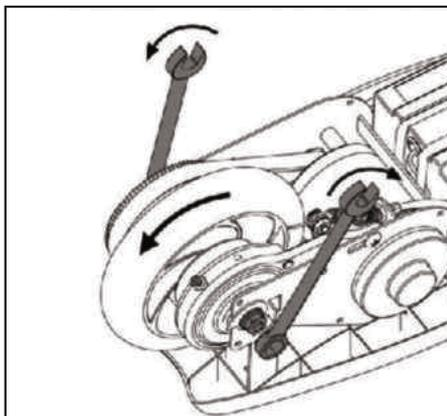
7. Depois de apertar as porcas de eixo com uma chave de 13mm, verificar o alinhamento das rodas e do piso da correia rodando a roda no sentido contrário ao dos ponteiros do relógio à mão. Poderá ser necessário ajustar as arruelas de ajuste para alinhar a correia
