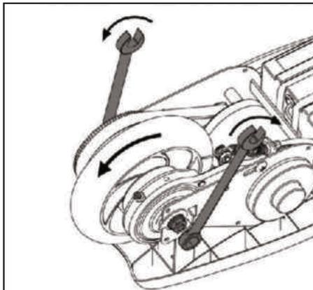
7. Assicurarsi che le rondelle di regolazione siano posizionate correttamente contro il telaio. Dopo aver serrato i dadi dell'asse con una chiave da 13 mm, controllare l'allineamento delle ruote e il battistrada della cinghia ruotando a mano la ruota in senso orario opposto. Potrebbe essere necessario regolare le rondelle per allineare la cinghia.
