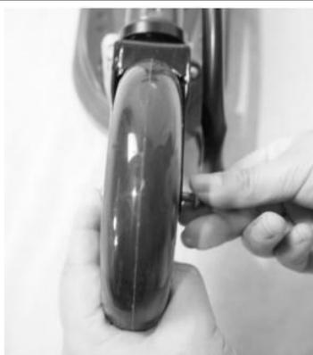
5. Inserir o parafuso do eixo no orifício do garfo dianteiro.
