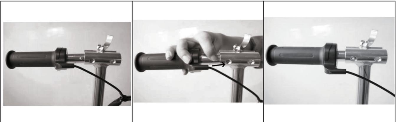
2. Insérez le guidon droit de l'accélérateur et utilisez le doigt pour appuyer sur la goupille à pression pour l'insérer et la fixer dans le trou de la barre en T du guidon.
