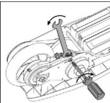
8. Voltar a apertar o braço do travão parafuso com um Phillips chave de fendas e chave inglesa de 8mm.
