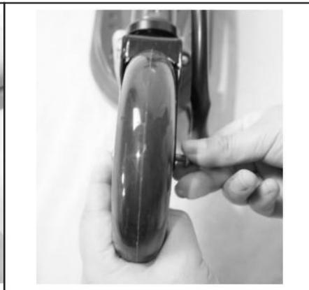
5. Inserte el tornillo del eje en el orificio de la horquilla delantera.
