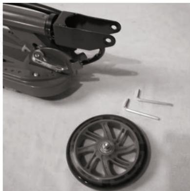
2. Sortez la roue avant et les deux clés hexagonales de 5mm pour l'assemblage.
