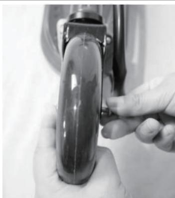
5. Insérez la vis de l'axe dans le trou de la fourche avant.
