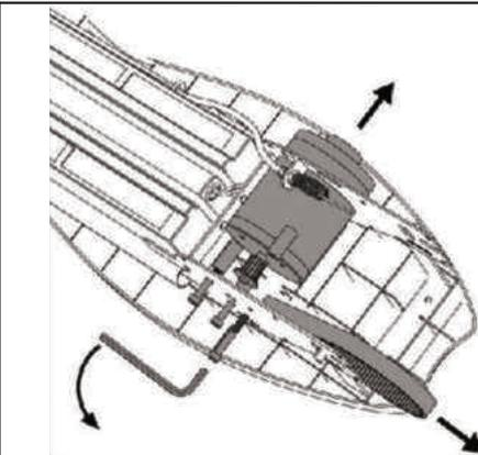
5. Se si sostituisce la cinghia, rimuovere i bulloni del motore con una chiave esagonale da 5 mm. Far scorrere il motore leggermente fuori dal telaio in modo da avere spazio sufficiente per rimuovere / sostituire la cinghia nell'ingranaggio della monopattino. Riposizionare i distanziali e serrare nuovamente i piedini.
