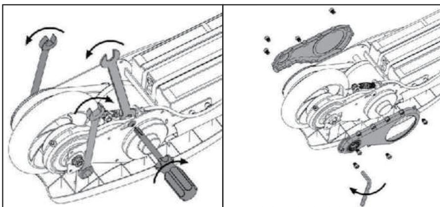
4. Assurez-vous que la roue est alignée dans le cadre et serrez les deux écrous de l'essieu avec une clé de 13 mm. Resserrez le bras de frein avec un tournevis Phillips et une clé de 8 mm.
