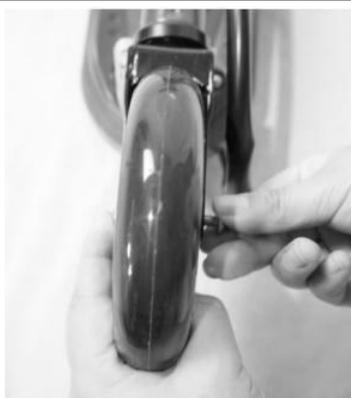
5. Inserire la vite dell'asse nel foro della forcella anteriore.
