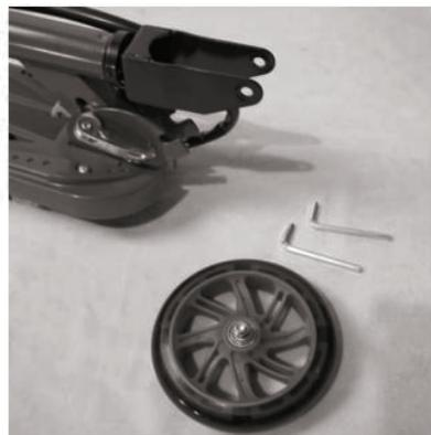
2. Separar a roda dianteira e a chave hexagonal de 2\*5mm para montar.
