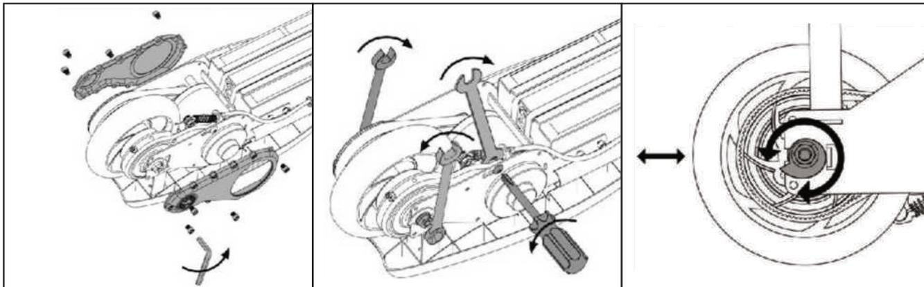
1. Con una llave hexagonal de 4 mm, retire los 3 tornillos de la cubierta protectora en ambos lados del scooter.
