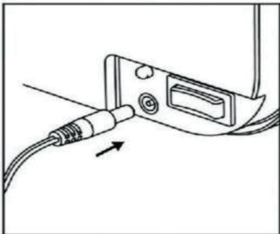
1. Assurez-vous que l'interrupteur est en position éteinte avant de brancher le chargeur, insérez le chargeur dans le port de charge situé sur le côté droit du boîtier de la batterie.
