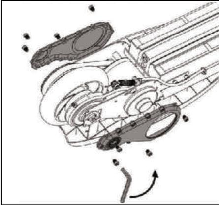
1. Utilizzando una chiave esagonale da 4 mm, rimuovere i 4 bulloni dalla copertura dell'asse posteriore su entrambi i lati del monopattino. (solo per il monopattino con i coperchi)
