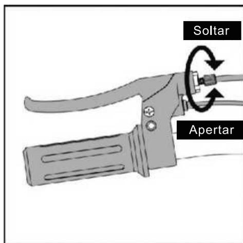
1. Para ajustar o cabo do travão, rodar o cilindro de ajuste na alavanca do travão no sentido dos ponteiros do relógio (para soltar) ou no sentido contrário ao dos ponteiros do relógio (para apertar). Ajustar o cilindro em pequenos incrementos para a regulação desejada. Se o travão ainda necessitar de ajuste, proceder ao passo seguinte.
