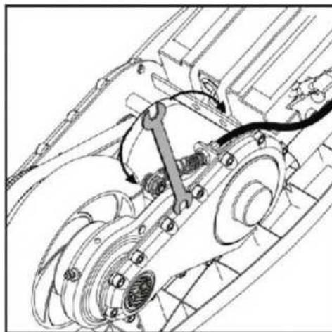
2. Si el cable del freno aún está demasiado tenso, use una llave de 10 mm para apretar el cable del freno para un ajuste adicional en el cable. Asegúrese de que la tuerca de 10 mm esté apretada después del ajuste.
