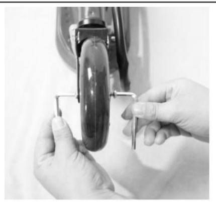
6. Use la llave hexagonal de 2x5 mm para insertar el tornillo del eje y fíjelo con una llave hexagonal.
