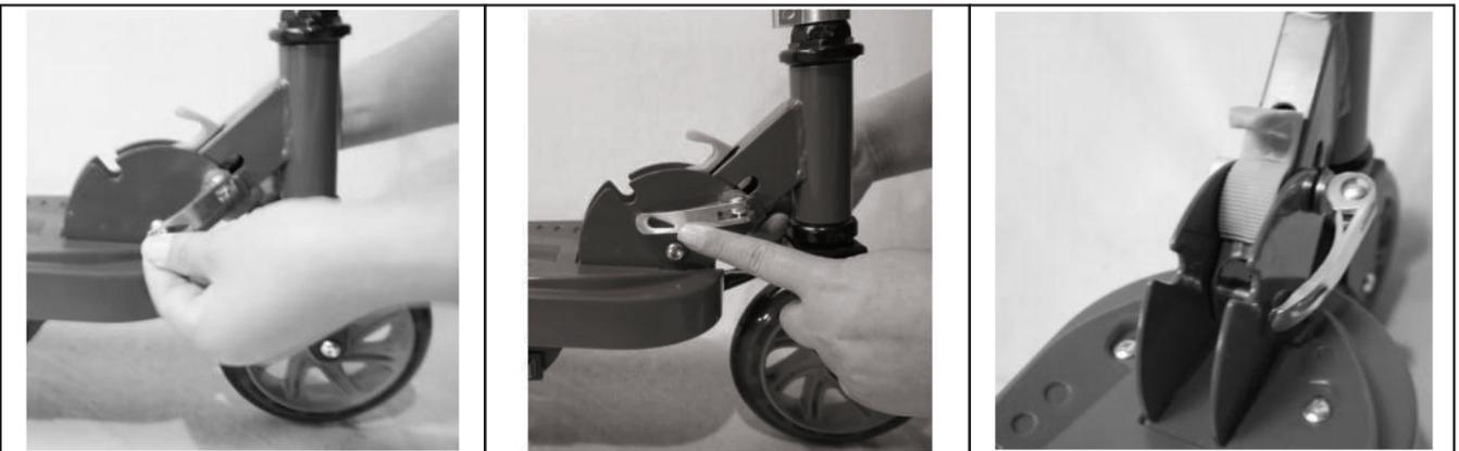
4. Gire el casillero del mecanismo de bloqueo, luego apriételo completamente y bloquéelo firmemente antes de conducir.
