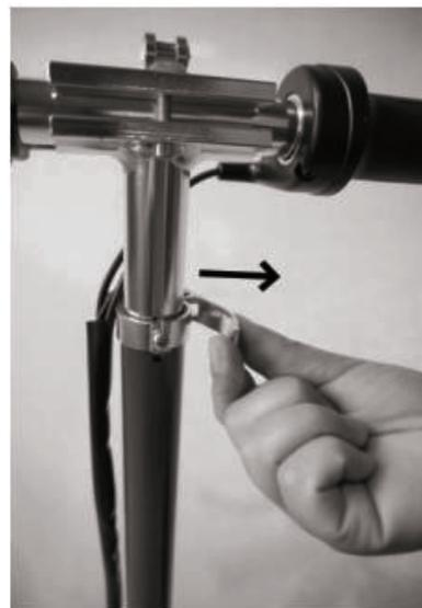
1. Aprire la leva di chiusura del tubo frontale e sollevare la barra a T fino alla prima posizione con la testina di blocco nel tubo anteriore.
