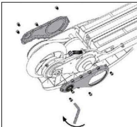
10. Réinstallez les couvercles latéraux avec une clé Allen de 4 mm. Ne serrez pas trop les vis.
