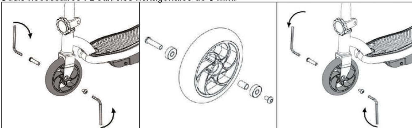
1. À l'aide de deux clés hexagonales de 5 mm, desserrez et retirez l'essieu avant en tournant les clés vers la gauche.
