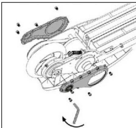
10. Vuelva a instalar las cubiertas laterales con una llave Allen de 4 mm. No apriete demasiado los tornillos.
