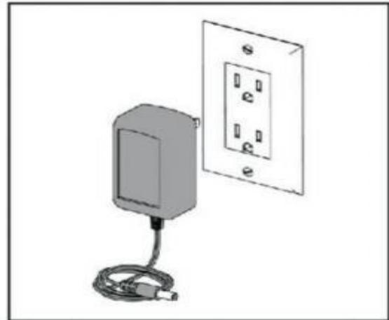
2. Enchufe el cargador en un tomacorriente de pared. La luz en la caja del cargador se iluminará. **La luz roja indica que la batería se está cargando.** **La luz verde indica que la batería está completamente cargada.**
