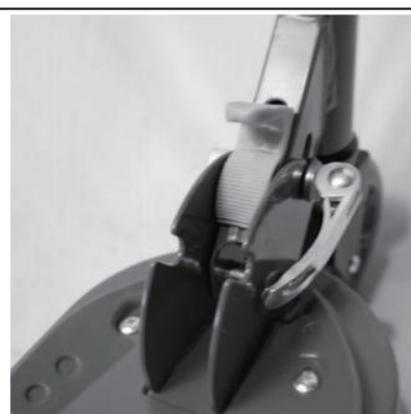
4. Tournez le verrou du mécanisme de verrouillage, puis serrez-le complètement et verrouillez-le avant de monter.
