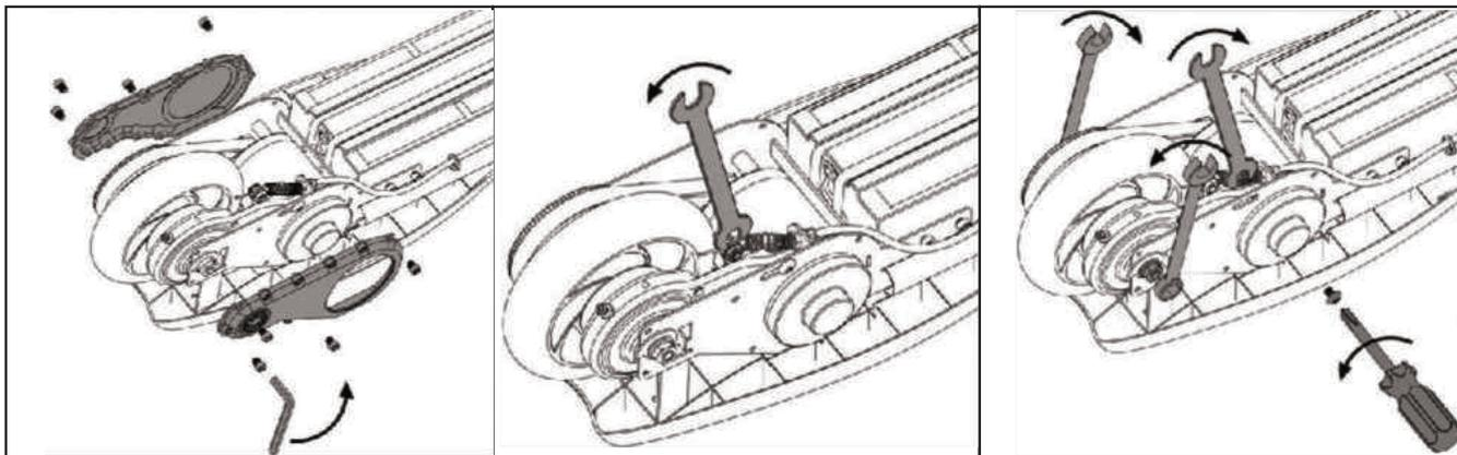
1. Usando uma chave hexagonal de 4mm, retire os 4 parafusos da cobertura do eixo traseiro em ambos os lados da trotinete. (Somente para a trotinete com coberturas.)
