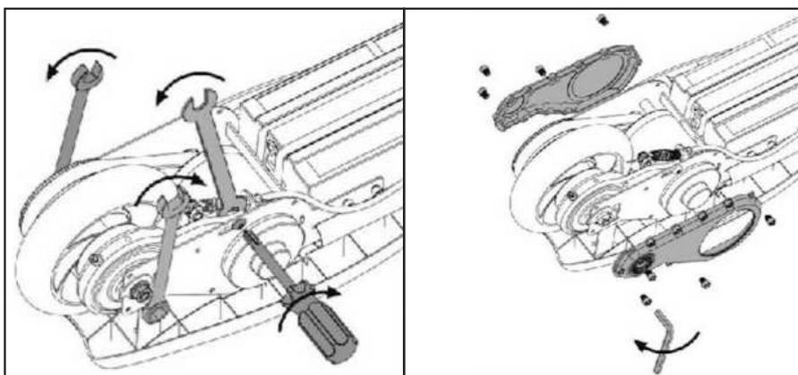
4. Assicurarsi che la ruota sia allineata al telaio e serrare i due dadi dell'asse con una chiave da 13 mm. Serrare nuovamente il braccio del freno con un cacciavite a croce e una chiave da 8 mm.
