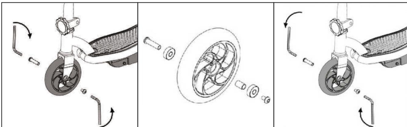
1. Utilizando duas chaves sextavadas de 5mm soltar e remover o eixo dianteiro rodando as chaves para a esquerda.
