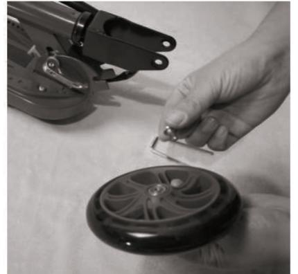
3. Saque el tornillo del eje en la rueda delantera.
