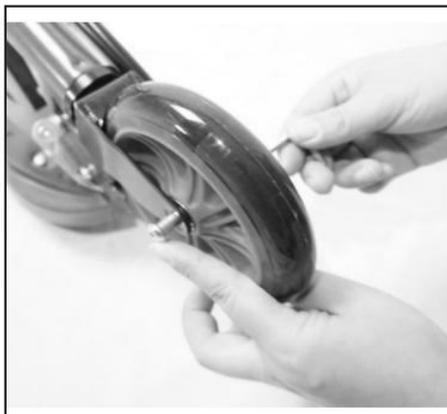
4. Usar a chave hexagonal de 1\*5mm para orientar e inserir o eixo no orifício do garfo dianteiro.
