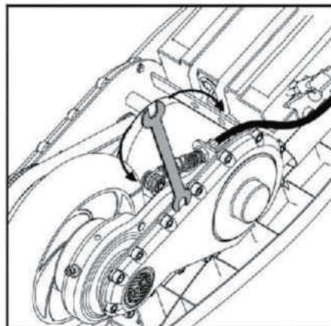
2. Si le câble de frein est encore trop tendu, utilisez une clé de 10 mm pour serrer davantage le câble de frein. Assurez-vous de resserrer l'écrou de 10 mm après ajustement.
