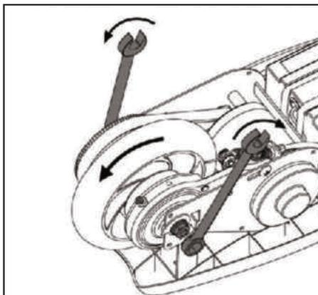
7. Assurez-vous que les rondelles de réglage sont correctement positionnées contre le cadre. Après avoir serré les écrous de l'essieu avec une clé de 13 mm, vérifiez l'alignement des roues et la bande de roulement de la courroie en tournant la roue dans le sens antihoraire à la main. Vous devrez peut-être ajuster les rondelles pour aligner la courroie.
