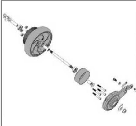
4. Prendere nota delle posizioni di tutti gli elementi della ruota posteriore e assicurarsi di reinstallare tutti gli elementi correttamente.
