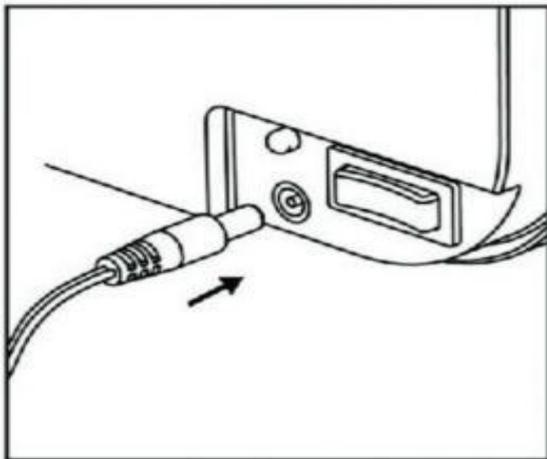
1. Assicurarsi che l'interruttore sia in posizione Off prima di collegare la caricabatteria. Inserire la caricabatteria nella porta di carica sul lato destro del vano della batteria.
