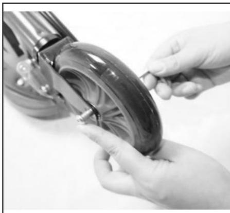
4. Utilizzare la chiave esagonale da 1\*5 mm per caricare e inserire l'asse nel foro della forcella anteriore.
