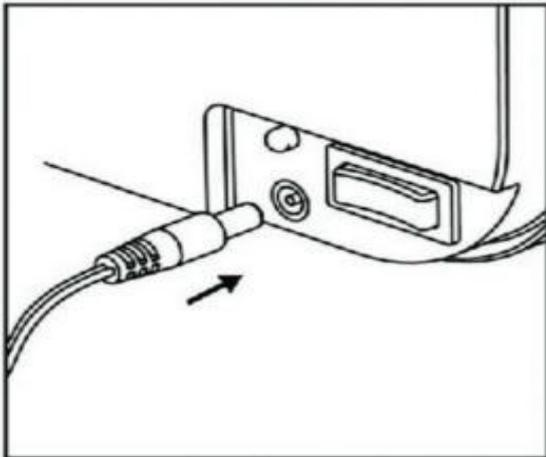
1. Asegúrese de que el interruptor esté en la posición de apagado antes de enchufar el cargador. Inserte el cargador en el cierre de carga en el lado derecho de la caja de la batería.
