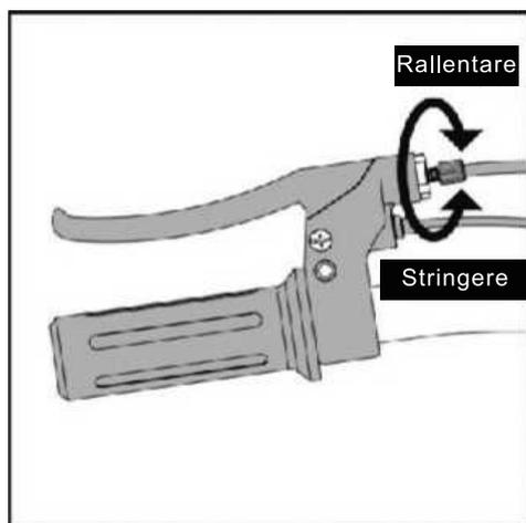
1. Per regolare il cavo del freno, ruotare il dado di regolazione sulla leva del freno in senso orario (per allentare) o antiorario (per stringere). Regolare il dado con piccoli incrementi fino alla regolazione desiderata. Se il freno deve ancora essere regolato, passare alla fase successiva.
