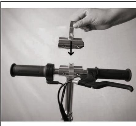
4. Presione hacia abajo y apriete el bloqueo en la barra en T del manillar.
