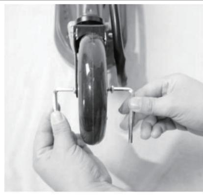
6. Utilisez les deux clés hexagonales de 5mm pour insérer la vis de l'axe et fixez-la avec une clé hexagonale.
