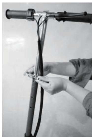
3. Verrouillez et serrez complètement le verrou dans le tube avant.
