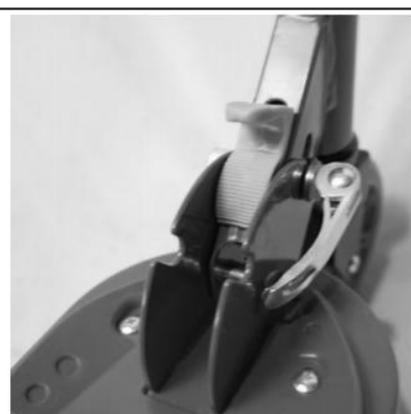
4. Ruotare la leva di chiusura del meccanismo di bloccaggio, quindi serrarla completamente e bloccarla prima della guida.
