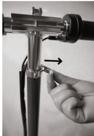
1. Ouvrez le verrou du tube avant et soulevez la barre en T jusqu'à la première position avec la goupille à pression dans le tube avant.
