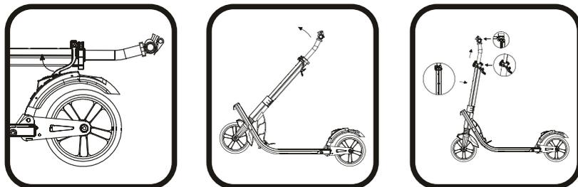
Tire del gancho de plástico hacia arriba para desbloquear el sistema de plegado y tire del vástago del manillar hacia abajo. Cuando suena un clic, el patinete está completamente desplegado.
