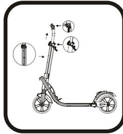
Ziehen Sie den Kunststoffhaken nach oben, um das Klappsysteem zu entriegeln, und ziehen Sie den Lenkervorbau nach unten. Wenn Sie ein Klicken hören, ist der Scooter vollständig ausgeklappt.
