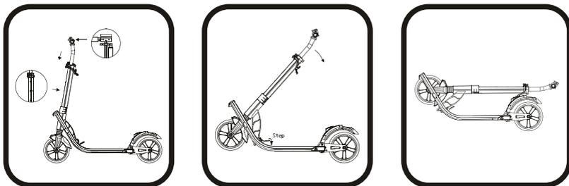
Afloje el bloqueo rápido, presione el botón de resorte y presione la barra en T al nivel de altura más bajo. Luego apriete el bloqueo rápido para asegurar la barra en T.
