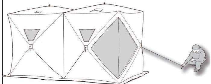
Trouvez le côté de la tente de pêche qui fait face au vent, et attachez l'une des sangles fournies aux moyeux centraux de ce mur. Étirez la sangle dans le vent et avec le reste de la pointe de glace, fixez la sangle à la glace
