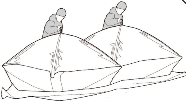
Poussez fermement vers le bas sur le moyeu central (s) du toit avec la paume de votre main jusqu'à ce que le toit s'aplatisse sur les côtés.
