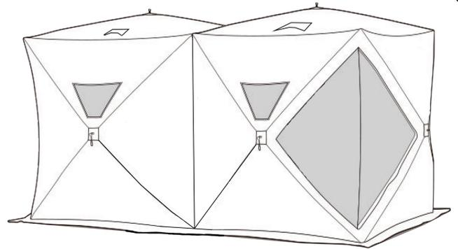
Soulevez le toit de l'abri vers le haut, tirez vers l'extérieur sur le centre de l'un des murs. Continuez autour de l'abri entier, tirez chaque moyeu de mur jusqu'à ce que tous les murs soient mis en place.
