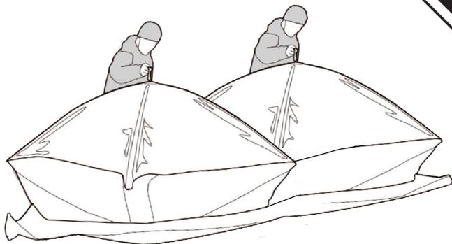
Tirez fermement vers le haut sur la sangle dans le moyeu central du toit jusqu'à ce qu'il ressorte. Tournez le toit de sorte que les coins du haut et du bas soient alignés.
