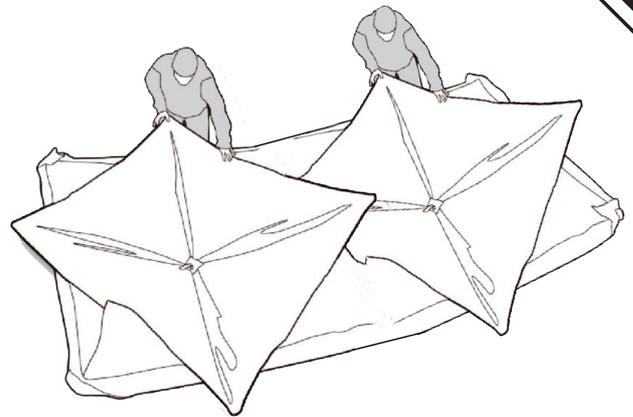
Une fois que l'appareil est posé à plat, soulevez chacun des coins ensemble et tenez l'appareil plié avec tous les moyeux orientés vers le bas.
