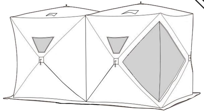
Poussez fermement sur l'un des centres-centres de l'extérieur. Continuer autour de l'extérieur de la tente de pêches et effondrez tous les murs restants jusqu'à ce que l'appareil repose à plat.
