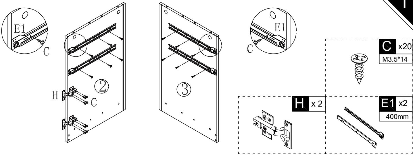
EN\_Please find the exact hole for installation, otherwise it will be misaligned. The screws on the drawer slide must be leveled , otherwise it will affect the smoothness of the d rawer. FR\_Identifiez le trou exact pour l'installation, sinon il sera mal aligné. Les vis de la glissière du tiroir doivent être nivelées, sinon cela affectera le fonctionnement du tiroir.
